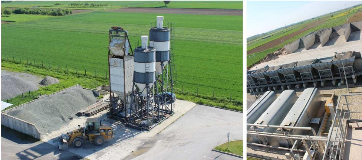
Na asfaltnoj bazi u Petrijevcima studente su dočekali djelatnici poduzeća Gradnja d.o.o. te ih detaljno upoznali s cjelokupnim procesom proizvodnje asfaltnih mješavina - od faze pripreme, proizvodnje i transporta asfaltne mješavine do mjesta gradnje te potrebnih laboratorijskih ispitivanja u okviru programa kontrole kvalitete.
