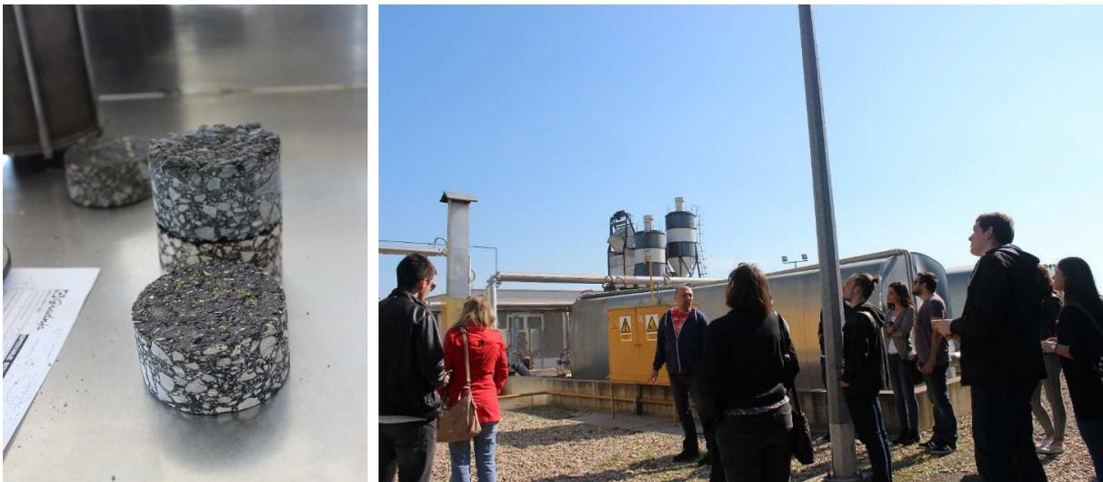
Asfaltna baza je kapaciteta 160 t/h, ekološkog je plinskog pogona (dnevna potrošnja u procesu proizvodnje 250 m<sup>3</sup>), digitalnog sustava upravljanja. Godišnje se u asfaltnoj bazi proizvede oko 60.000 tona asfalta, od toga 60% čine asfaltne mješavine za nosive slojeve, a ostatak za habajući sloj. Zanimljiv je podatak da su u prošloj godini od ukupne količine asfalta proizveli samo 1.800 tona SMA (splitmastiksasfalta).
