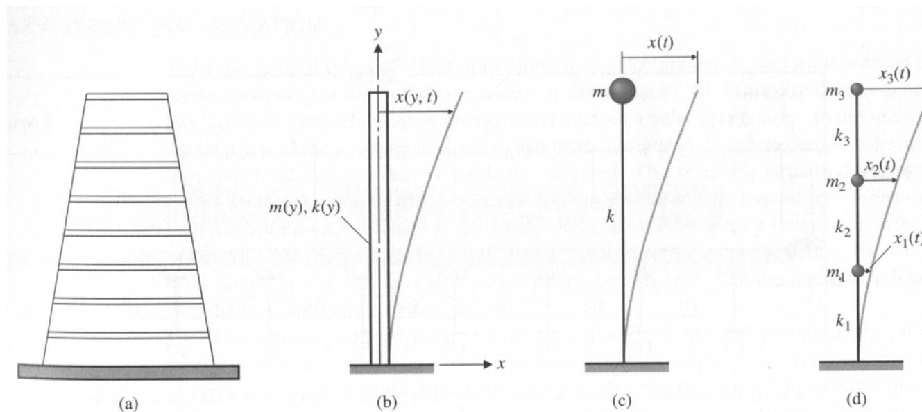
Mehanički model višekatne zgrade: a) fizikalni prikaz; b)kontinuirani model; c) diskretni model s jednim stupnjem slobode; d) diskretni model s tri stupnja slobode.
