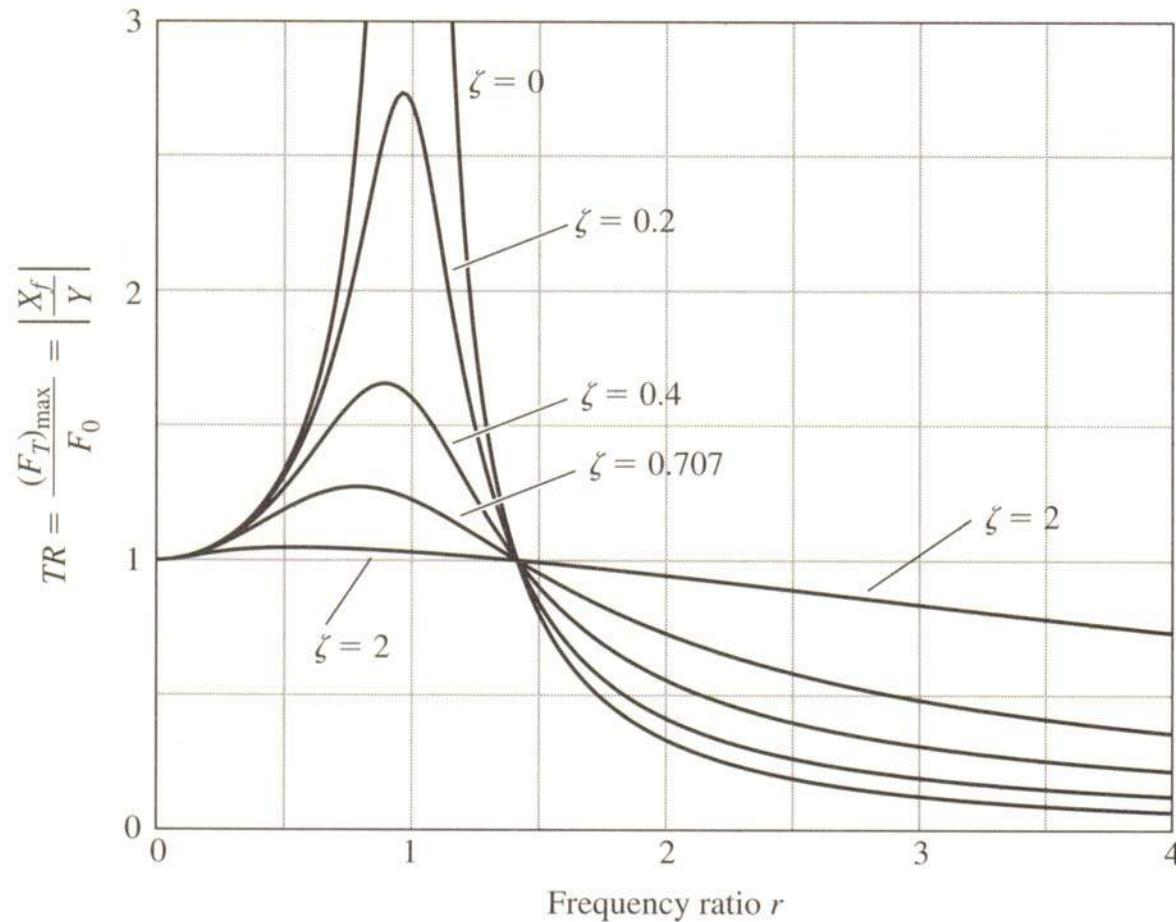
Prenosivost **TR** kao funkcija omjera frekvencija i prigušenja
