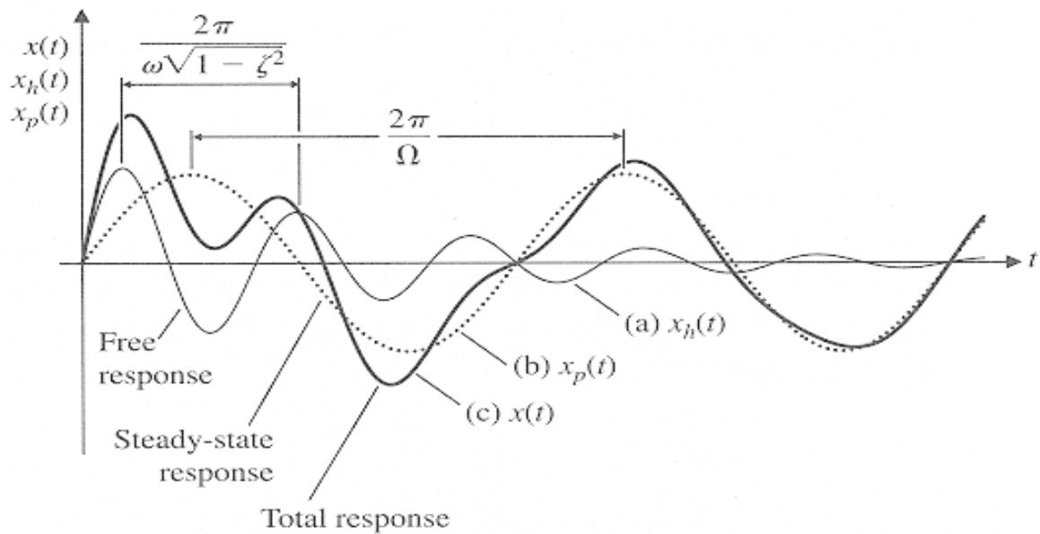
Odziv viskozno prigušenog sustava s jednim stupnjem slobode na harmonijsku uzbudu
