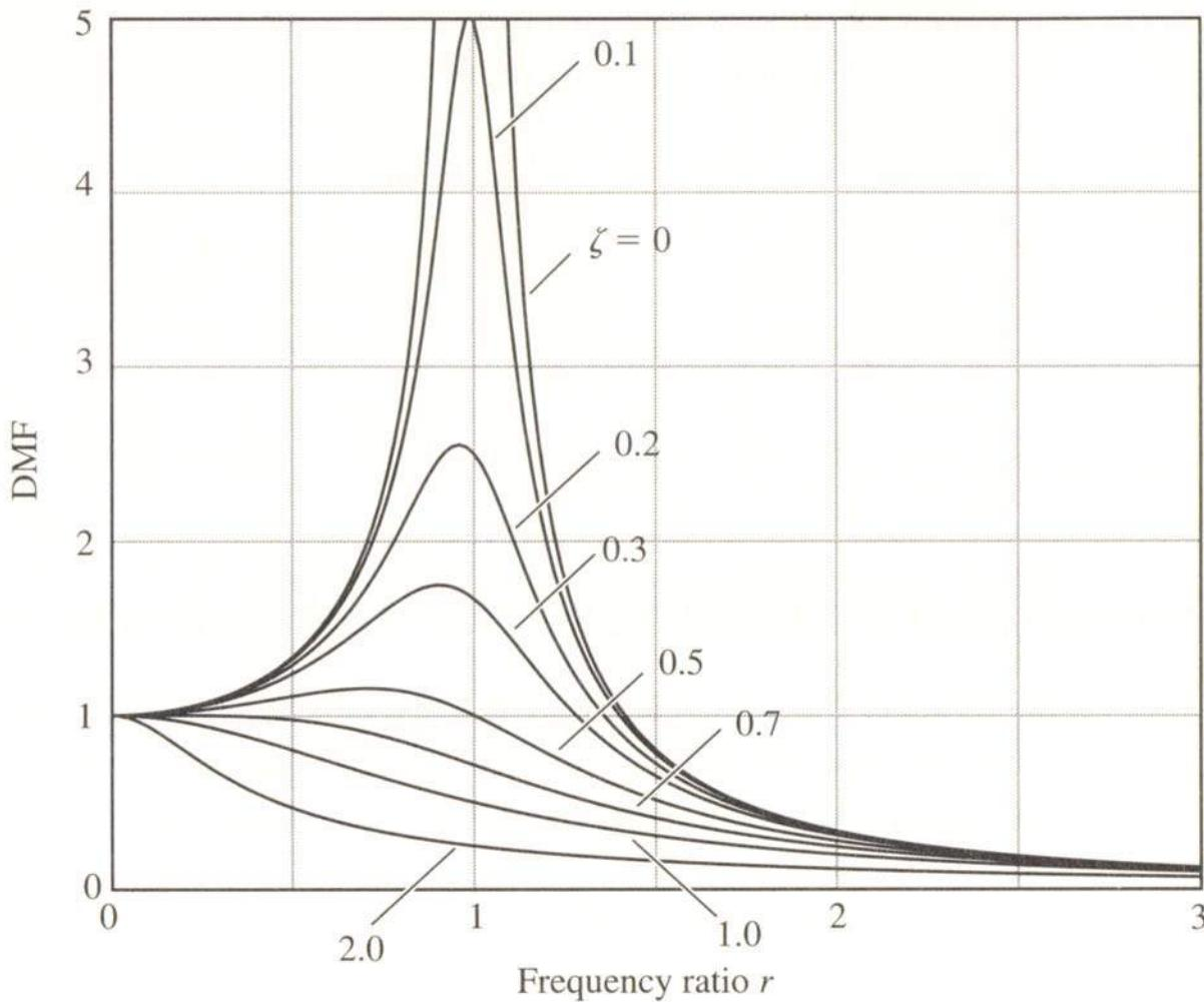
Odnos koeficijenta dinamičkog uvećanja (DMF) i omjera frekvencija  $r$  za različite stupnjeve prigušenja
