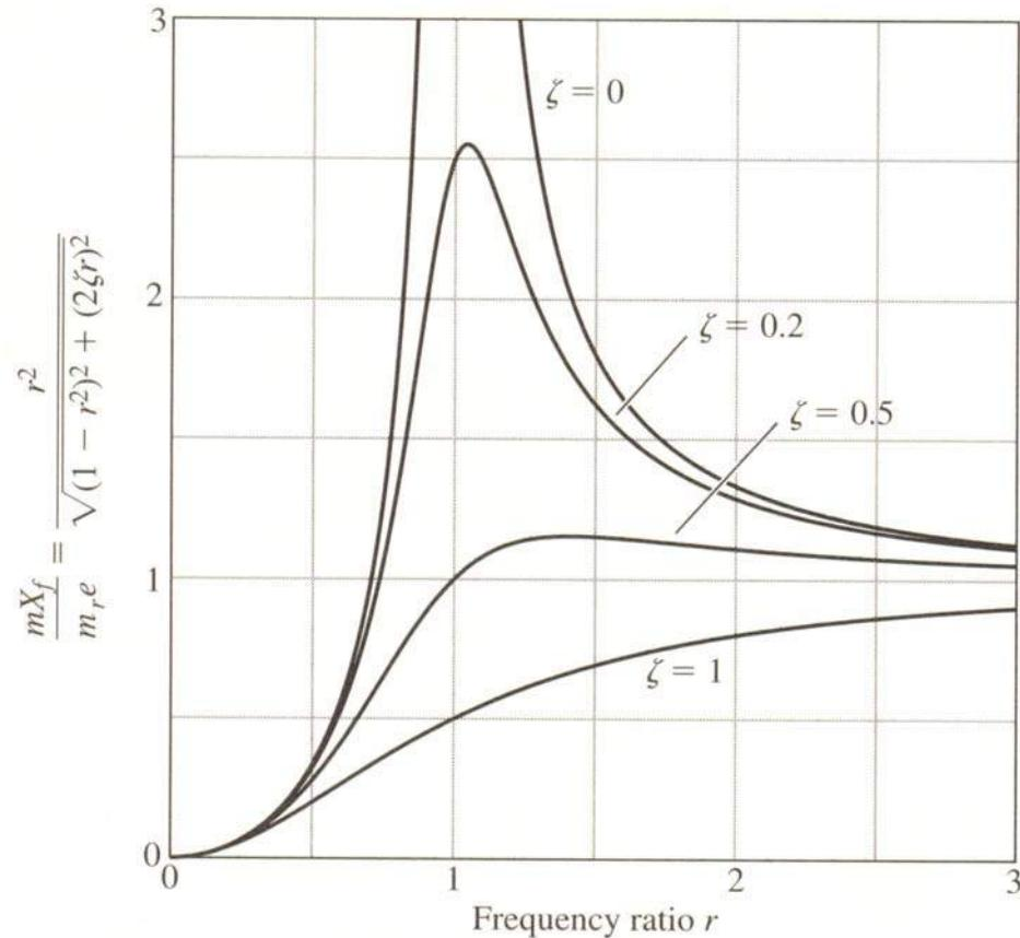
Trajni dio amplitude odziva SDOF sustava s ekscentričnom rotacijom
