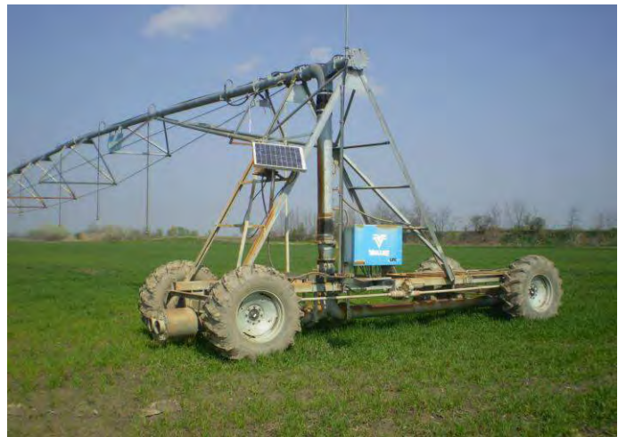
Linear od 743 m vodi se pomoću podzemnog antenskog kabla;
