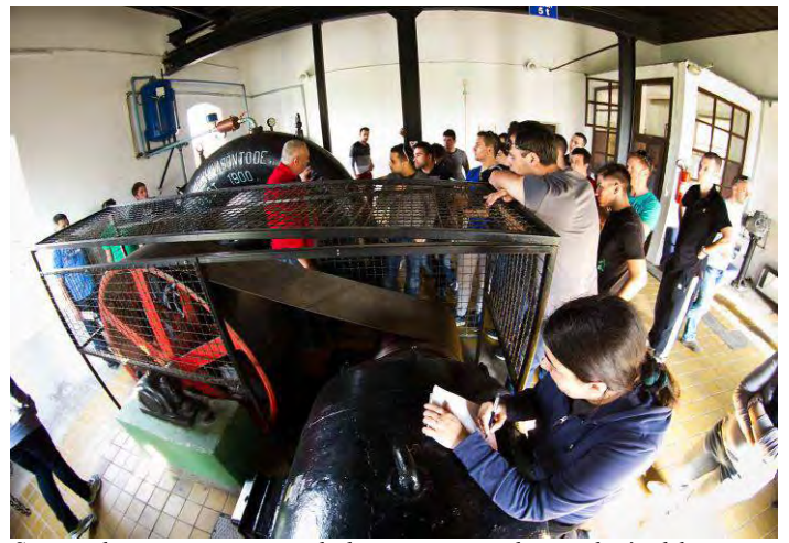
Stara crpka i remeni prijenos nekad na parni pogon danas pokreće elektromotor;
