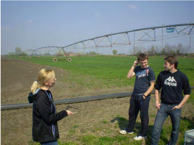
Linearni stroj za navodnjavanje s bočnim napajanjem iz hidranata;
