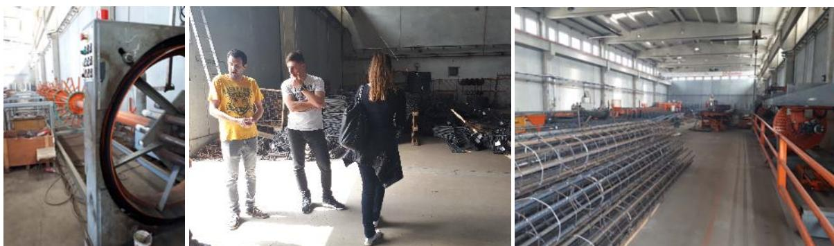
U okviru posjeta studenti su obišli i tvornicu armature s tehnološkim linijama za obradu armature iz šipke i koluta kapaciteta 3.000 kg/h. U armiračkom pogonu studentima je opisan rad stroja za automatsku izradu vilica, rad stroja za rezanje i oblikovanje armature, rad stroja za izradu armaturnih koševa za pilote te postupak nastavljanja armaturnih šipki zavarivanjem.
