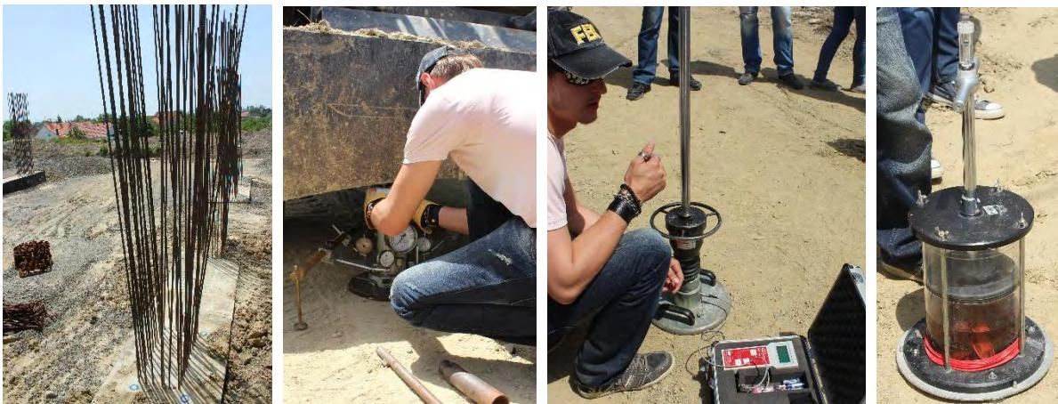
Na kraju obilaska gradilišta studentima su demonstrirana ispitivanja modula stišljivosti tla standardnom statičkom pločom i dinamičkom kružnom pločom te objašnjena primjena volumometra za mjerjenje gustoće tla. Demonstraciju različitih ispitivanja za potrebe kontrole kvalitete izvođenja prometnih površina pokazao je Vedran Tomala, prom.teh. iz Instituta IGH d.d. detaljno opisujući svako ispitivanje.
