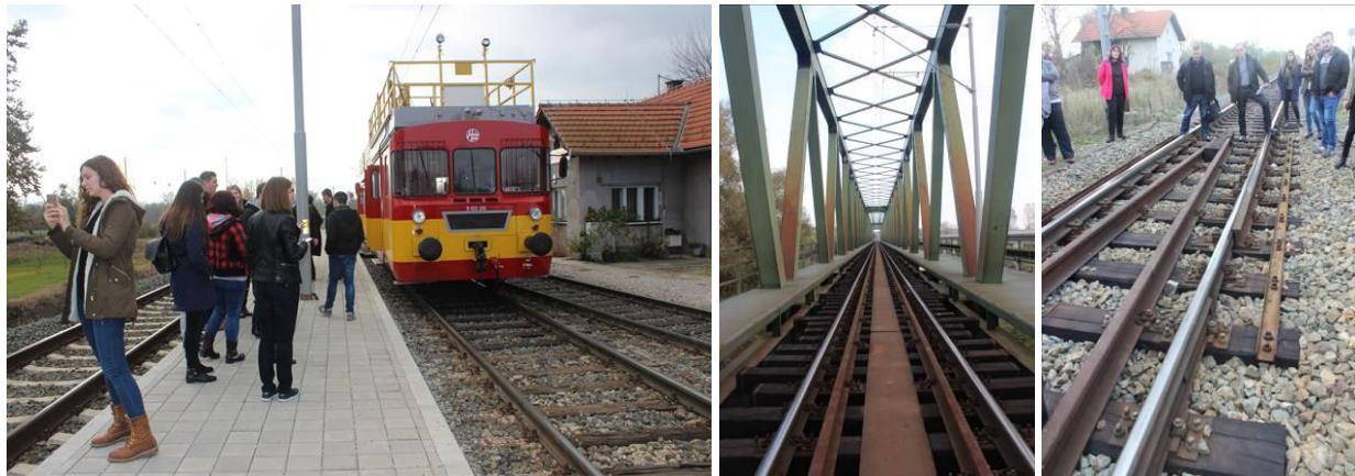
Prije remonta pruge najveća dopuštena vozna brzina vlakova iznosila je 80 km/h, uz daljnju tendenciju smanjivanja brzina, Radovima kapitalnog remonta na pruzi Koprivnica-Botovo-DG. dopuštene su najveće vozne brzine od 140 km/h. Jedino ograničenje brzine na 100 km/h vrijedi za izlazni zavoj iz kolodvora Koprivnica.
