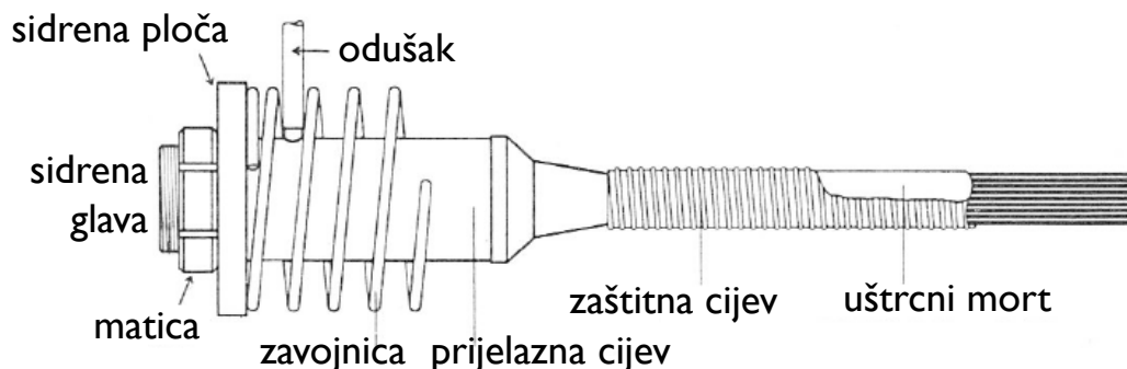
Slika 6.5: Inačica sidra s prstenastom glavom
