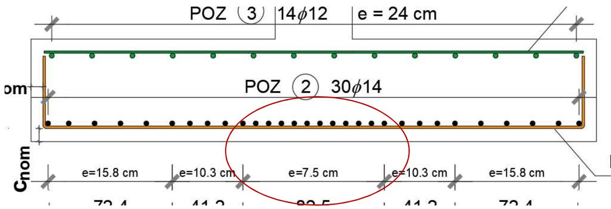
$$e_{min} = \{k_1 \cdot \phi; d_g + k_2; 20 \text{ mm}\} \quad k_1 = 1 \\ k_2 = 5 \text{ mm} \\ d_g \quad \text{najveće zrno agregata}$$
