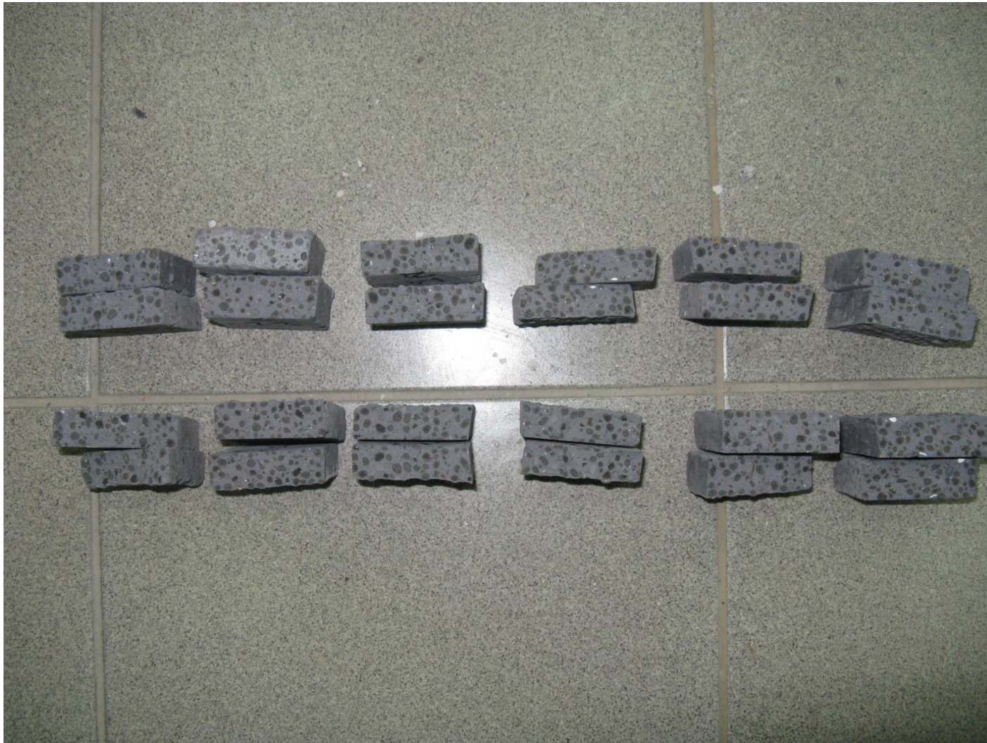
Izgled betona sa umjetnim agregatom
