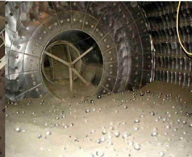
Unutrašnjost mlina s kuglama
