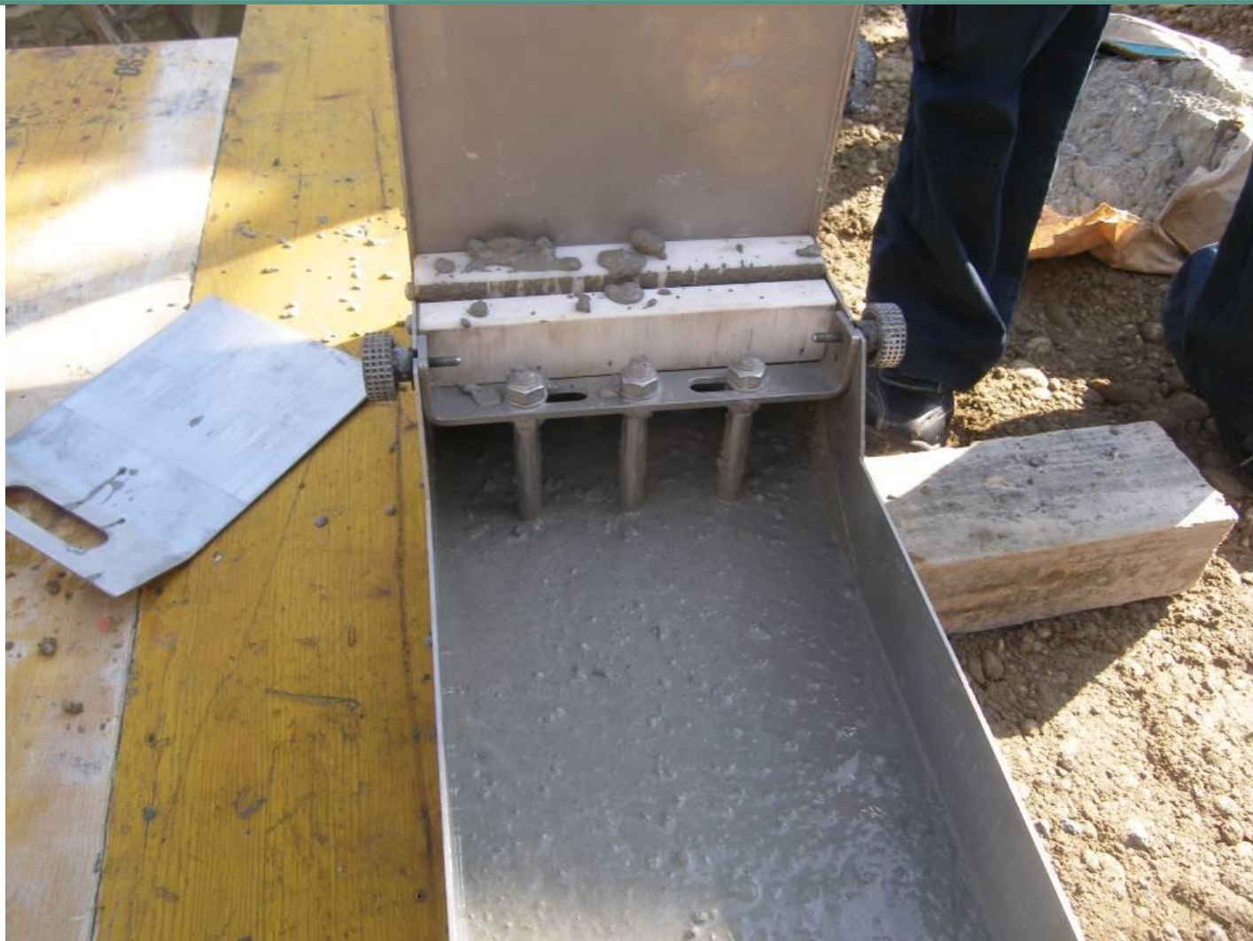
Ispitivanja sposobnosti zaobilaženja prepreka L – kutijom
