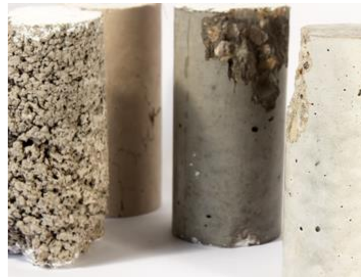
Uzorci kocke i valjka mikroarmiranog betona
