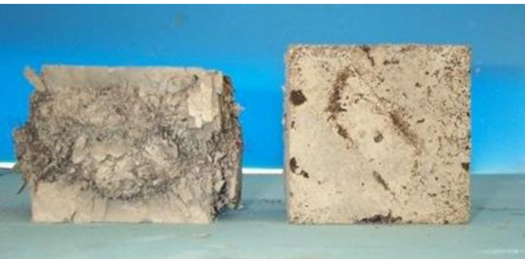
Uzorci kocke i valjka mikroarmiranog betona
