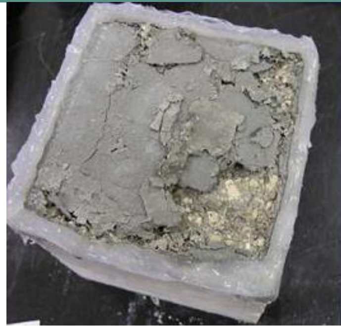
Primjer betona koji ne zadovoljava uvjete otpornosti na djelovanje smrzavanja i soli za odmrzavanje
