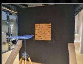
Ispitivanje EM zaštite na modelu simulirane prostorije i donošenje zaključka o ukupnoj zaštiti na temelju rezultata.
