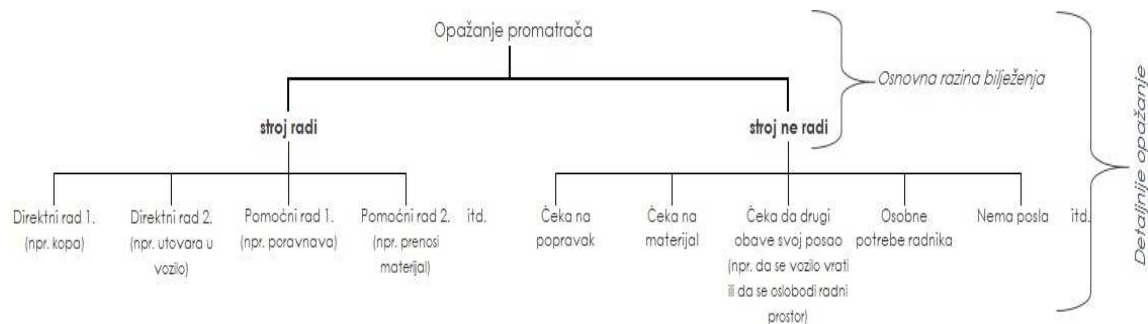
Slika 3.5 Moguće razine detaljnosti opažanja kod uzorkovanja rada stroja (prilagođeno prema [ILO, 1992])
