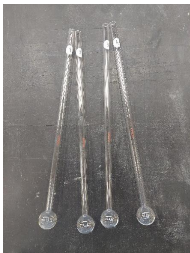
Slika 6.3. Priprema uzoraka za ispitivanje specifične površine
