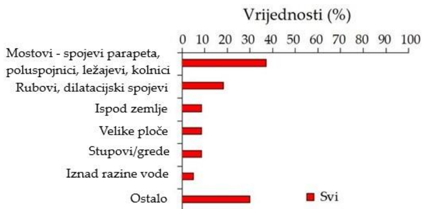
Slika 1.4. Betonski elementi skloni raspucavanju [1]
