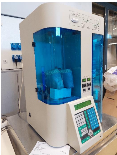
Slika 6.4. Priprema uzoraka za ispitivanje i uređaj za određivanje specifične površine BET metodom
