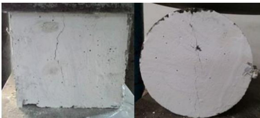
Slika 3.18. Proces prije pucanja betonskog uzorka [53]
