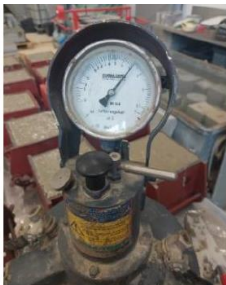
Slika 6.19. Određivanje udjela pora u betonu
