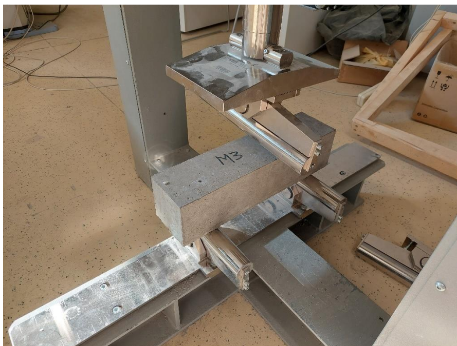
Slika 6.36. Ispitivanje vlačne čvrstoće betona savijanjem
