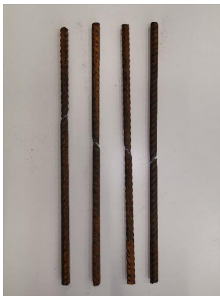
Slika 7.7. Ispitani uzorci uzdužne armature
