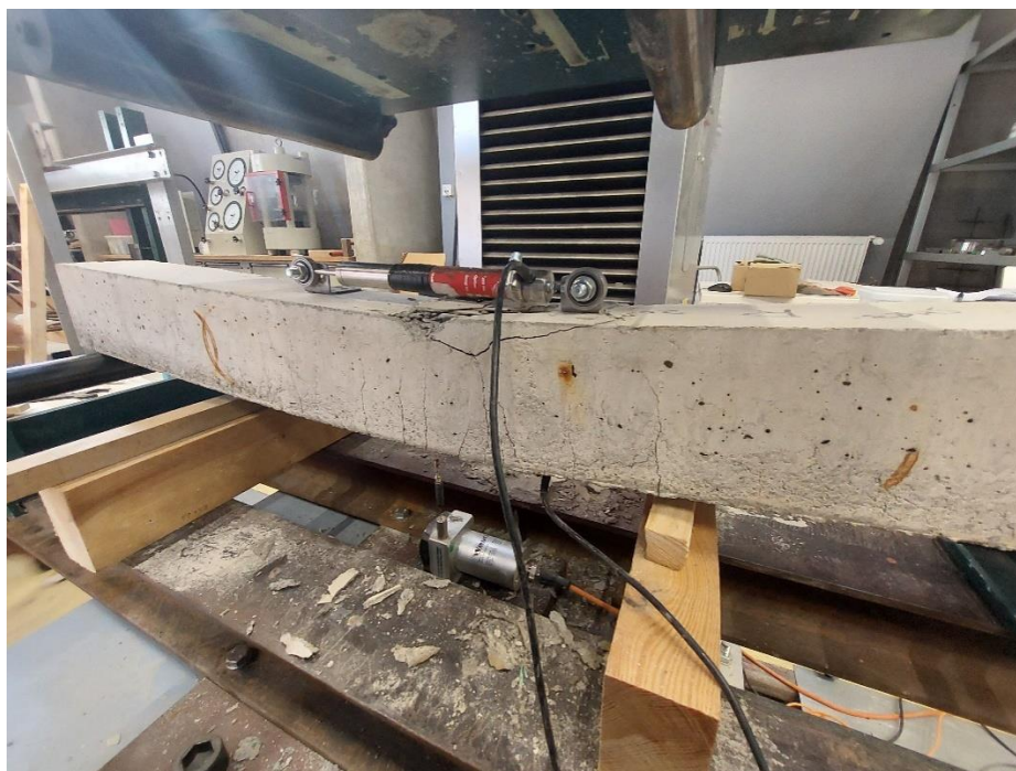
Slika 7.23. Izgled grede nakon sloma uslijed čistog savijanja
