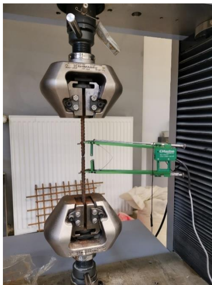
Slika 7.6. Ispitivanje uzdužne armature na kidalici Shimadzu
