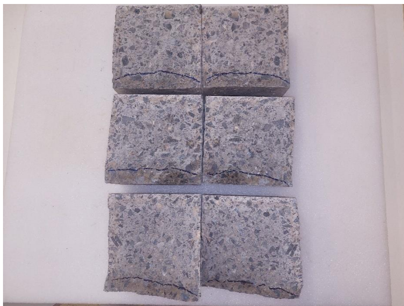
Slika 6.50. Uzorci nakon ispitivanja prodora vode pod tlakom
