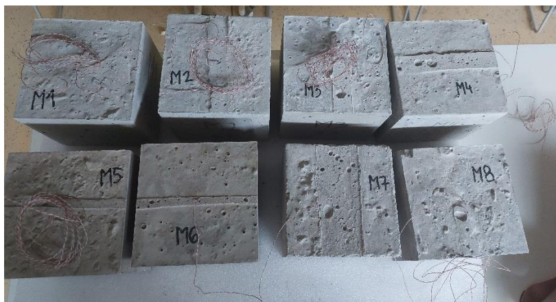
Slika 6.22. Kocke betona s ugrađenim termoparovima
