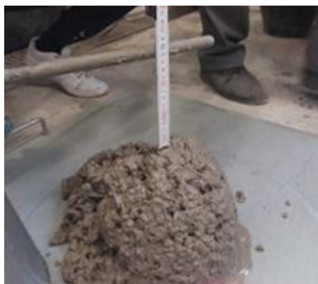
Slika 6.18. Određivanje konzistencije betona slijeganjem
