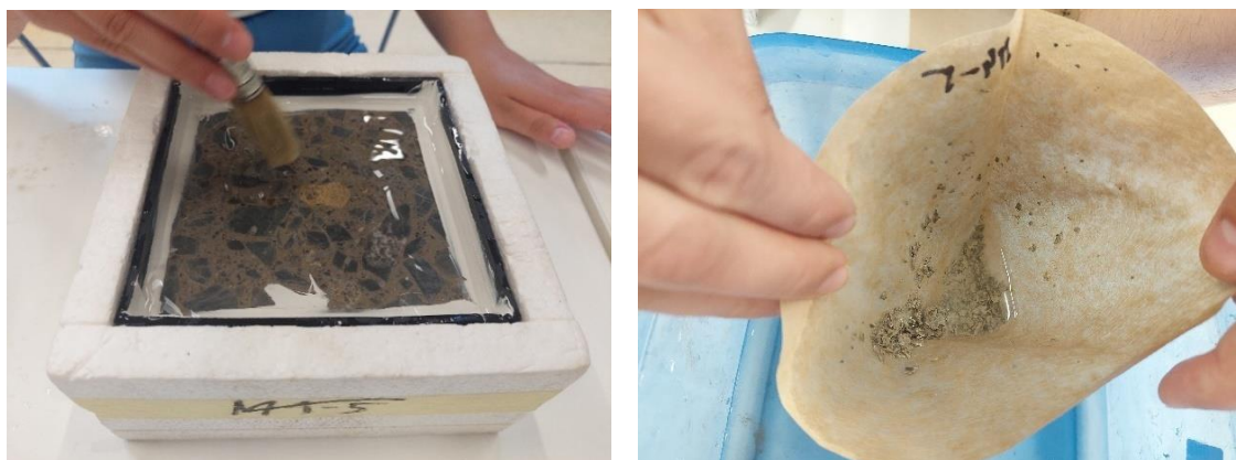
Slika 6.28. Ispitivanje otpornosti betona na cikluse smrzavanja/odmrzavanja-ljuštenje
