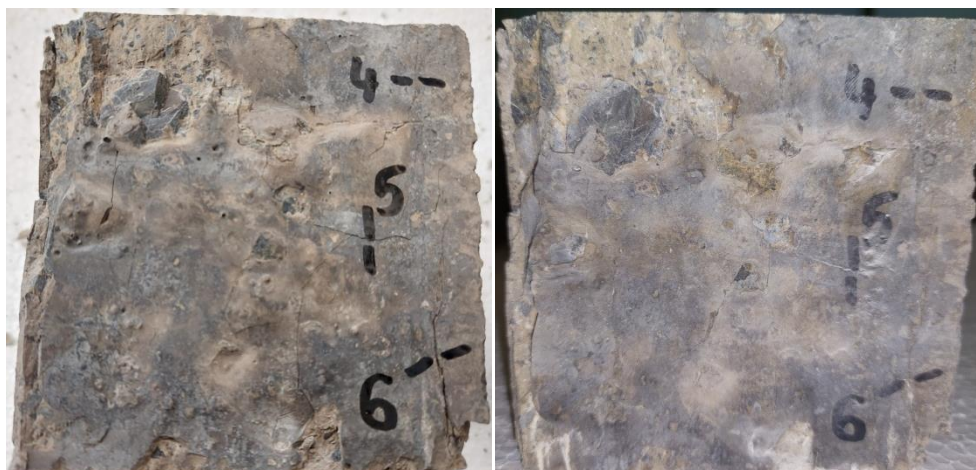
Slika 6.78. Mješavina M6 nakon smrzavanja i odmrzavanja (lijevo – prije samocijeljenja, desno - nakon samocijeljenja)
