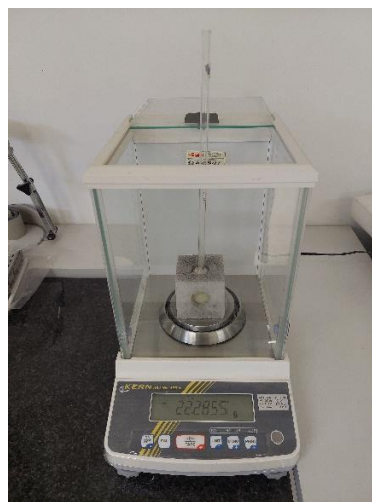
Slika 6.3. Priprema uzoraka za ispitivanje specifične površine
