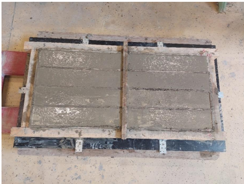
Slika 7.15. Svježi beton u oplati
