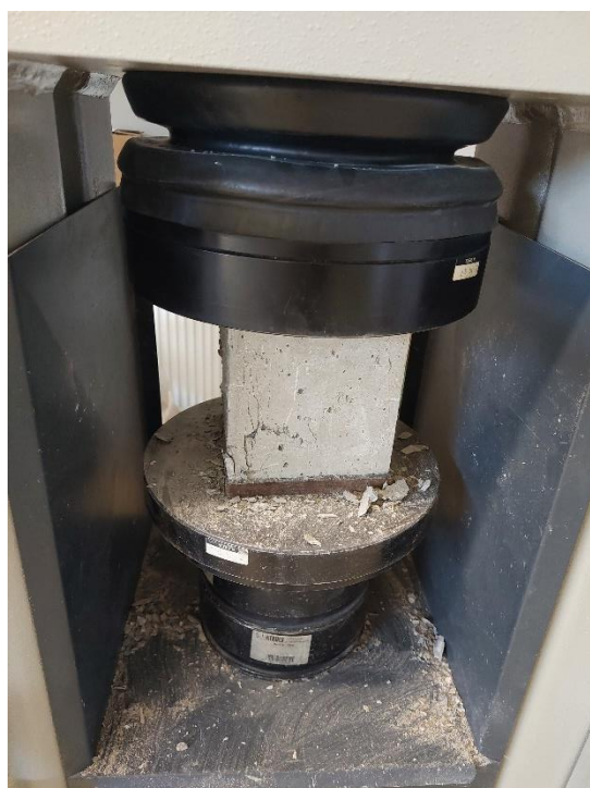
Slika 6.21. Ispitivanje tlačne čvrstoće betona
