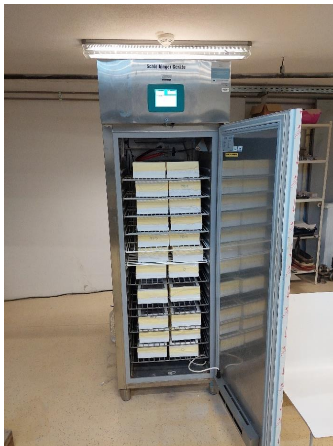
Slika 6.27. Uzorci betona u komori za smrzavanje i odmrzavanje
