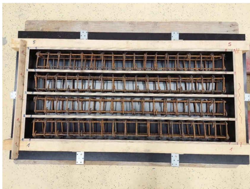
Slika 7.14. Oplata i armaturni koševi gredica
