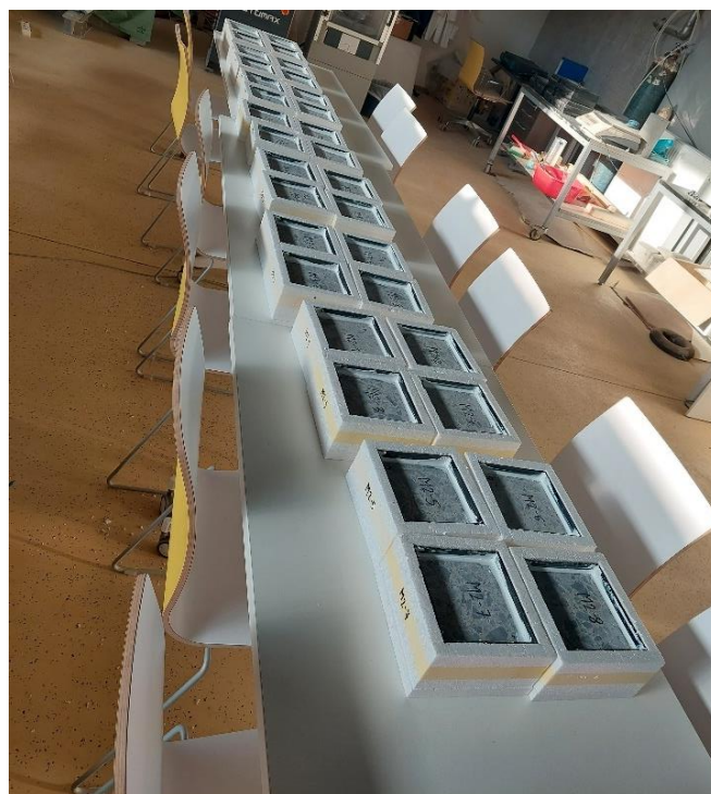
Slika 6.26. Plohe betona pripremljeni za ispitivanje otpornosti na cikluse smrzavanja/odmrzavanja
