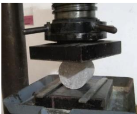
Slika 3.9. Proces iniciranja pukotina [51]
