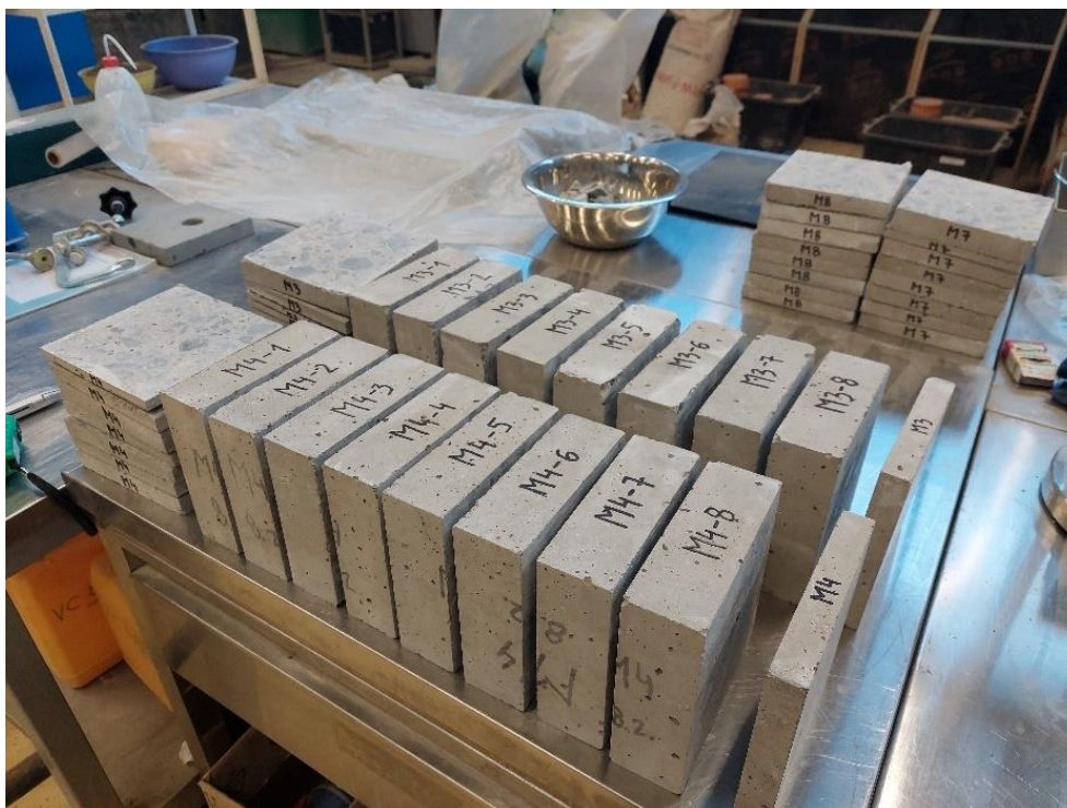
Slika 6.25. Plohe betona za ispitivanje otpornosti na cikluse smrzavanja/odmrzavanja
