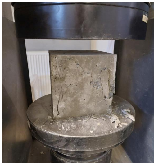
Slika 7.4. Ispitivanje tlačne čvrstoće betona
