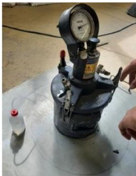
Slika 6.19. Određivanje udjela pora u betonu
