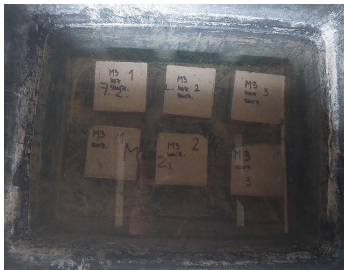
Slika 6.65. Samocijeljenje uzoraka mješavine M3 u vodi
