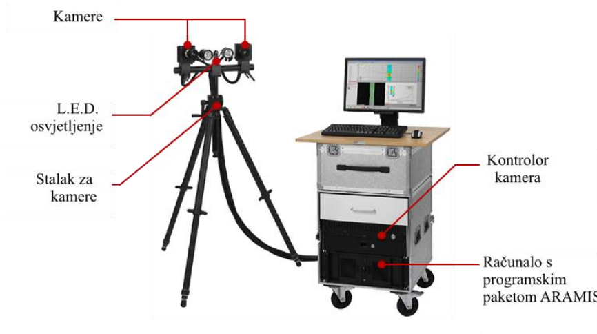
Slika 3.14. Sustav GOM ARAMIS za digitalnu stereo fotogrametriju
