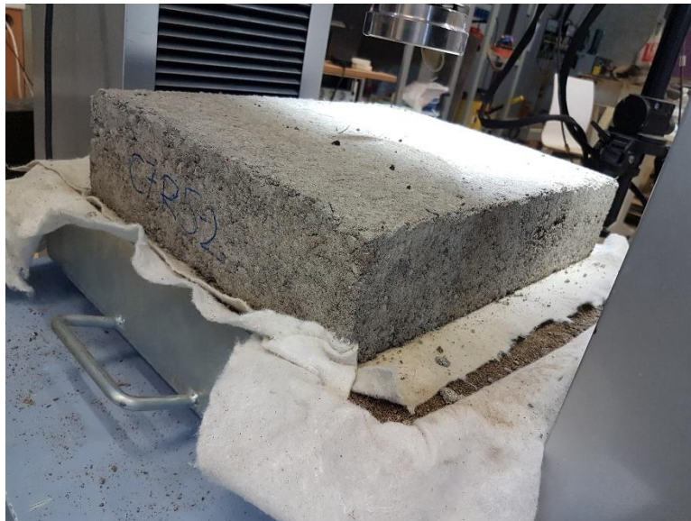
Slika 6.21. Ploča CNS – a sa 7% cementa i 5% gumenih niti nakon 4 ciklusa opterećenja
