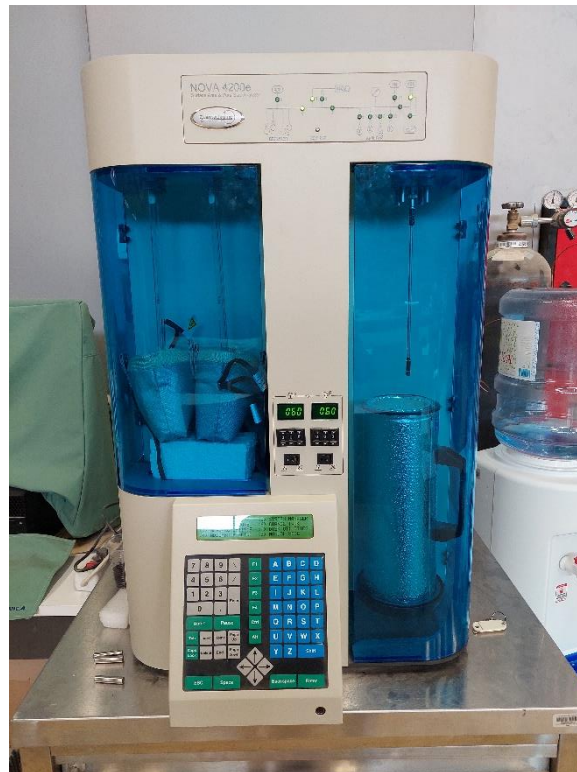
Slika 3.18. Uređaj za određivanje specifične površine materijala BET metodom
