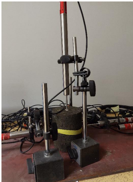
Slika 3.19. Mjerenje skupljanja uzorka
