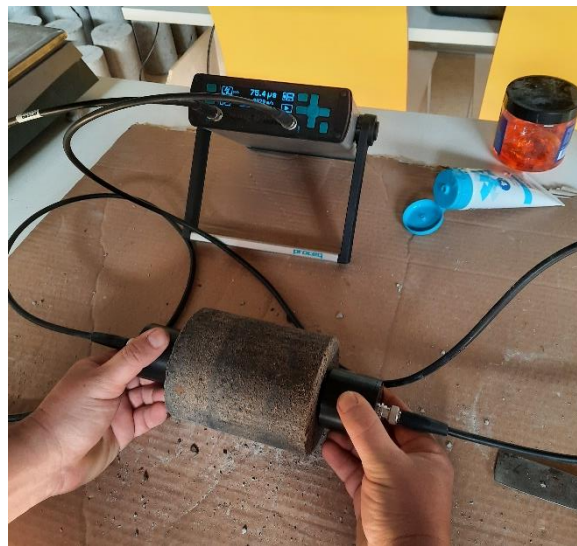
Slika 3.13. Mjerenje brzine ultrazvučnog impulsa
