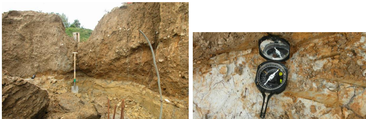
Slika 2. Na nastalom klizištu može se pažljivim otkapanjem ustanoviti klizna ploha, ako je plitko ispod površine na mjestu otkopa; prepoznata se kontaktna razlika raznih vrsta tla i eventualno i predominantna ploha klizanja ; nagib te plohe može pomoći u rekonstrukciji oblika ukupne klizne plohe
