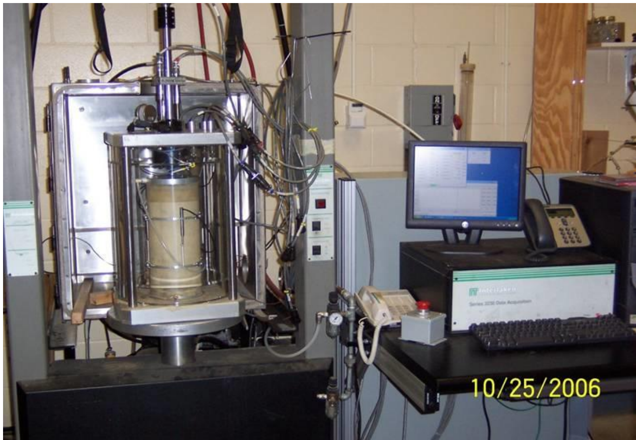
Slika 11. Troosna ćelija za ispitivanje resilient modula tla pod cikličkim opterećenjem
