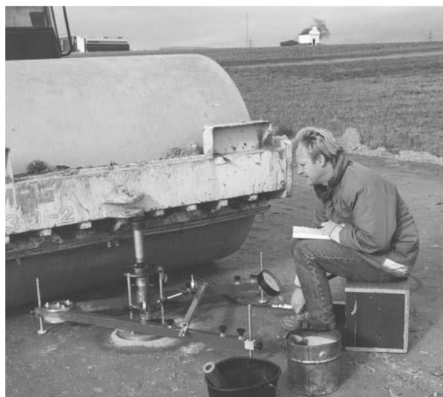
Slika 4. Pokus statičkim opterećenjem pločom
