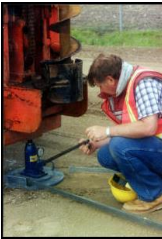
Slika 4. Pokus statičkim opterećenjem pločom
