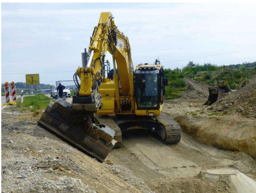
Novi bager Komatsu PC210LCi-11 tvornički je opremljen tehnologijom inteligentnog upravljanja strojevima
