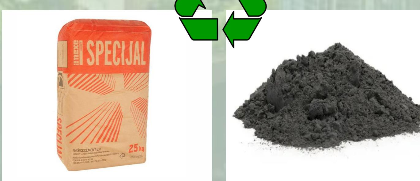
Leteći pepeo se već dugi niz godina primjenjuje u cementnoj industriji kao sirovina za proizvodnju cementa i betona s poboljšanim mehaničkim svojstvima.
