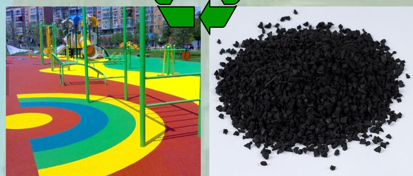
Reciklirana guma se nakon postupka usitnjavanja primjenjuje kod izrade podloga za dječja igrališta, betona za specijalne namjene, obloga i sl.
