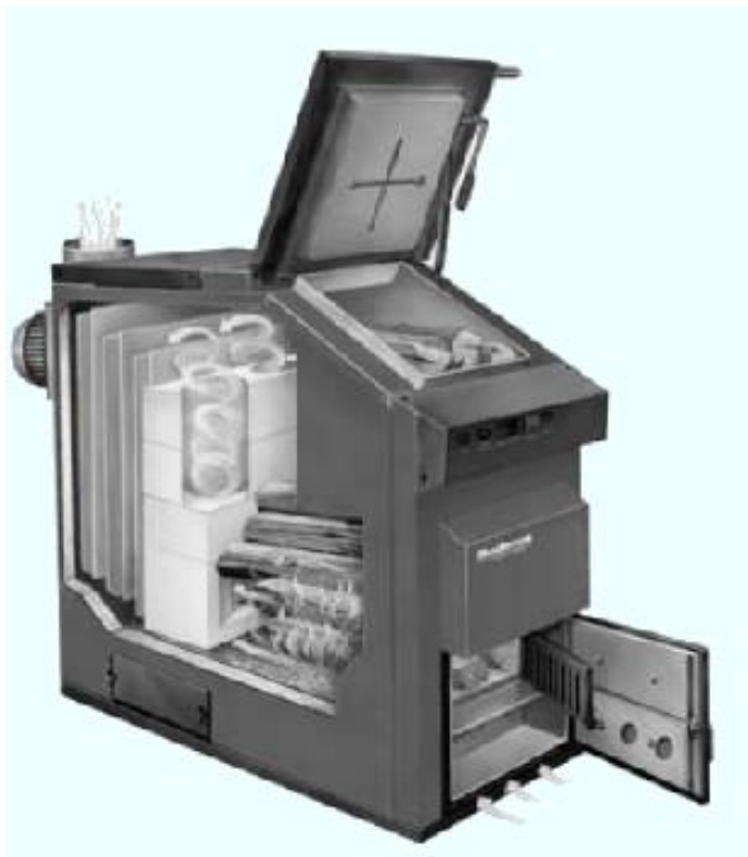
Toplovodni kotao za kruto gorivo s donjim izgaranjem u fluidiziranom sloju (Buderus Logano S321, 6-52 kW)
