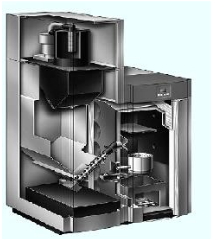
Specijalni kotao za drvene pelete stupnja korisnosti do 95% (Viessmann Vitolig 300, 5-15 kW)
