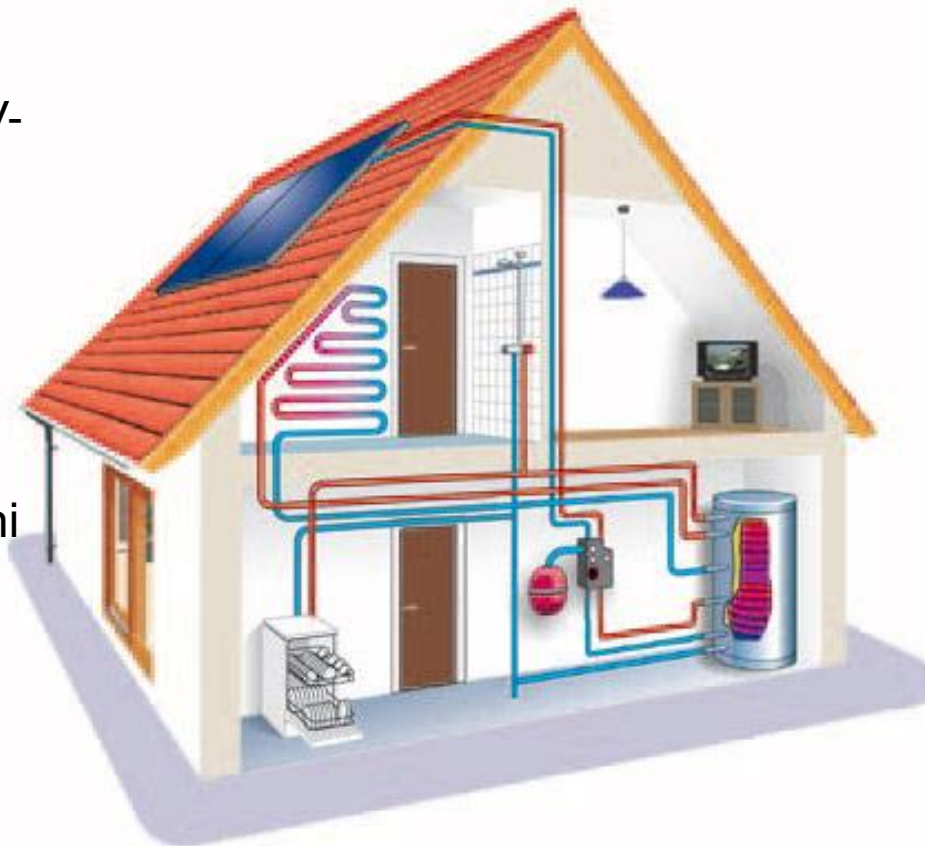
Konfiguracija sustava zagrijavanja PTV sa solarnim kolektorima
