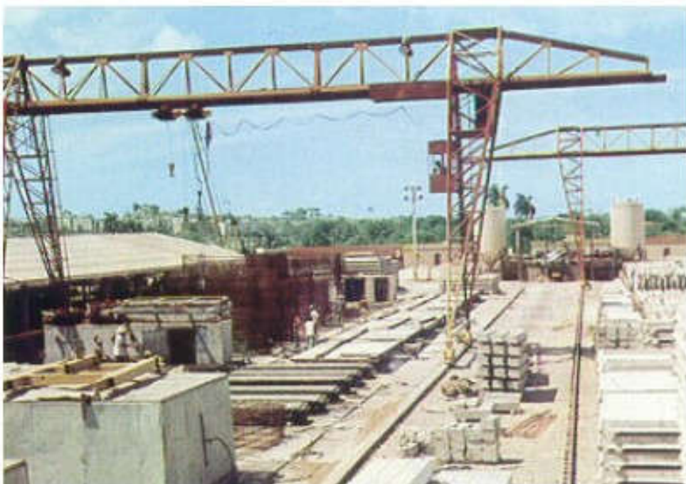
Proizvodnja IMS elemenata na otvorenim pogonima (gore) i u halama (dolje – “tvornice staniova”)
