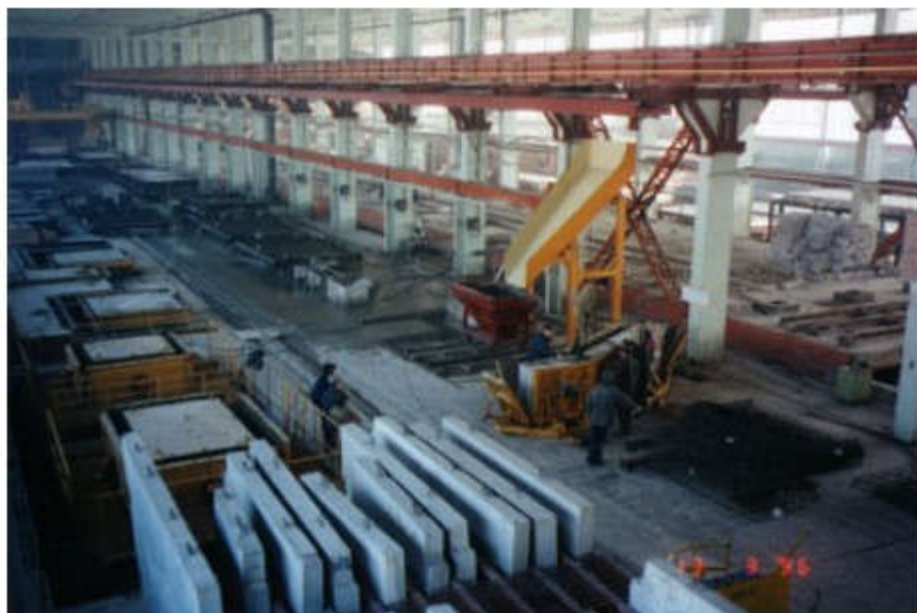
Proizvodnja IMS elemenata na otvorenim pogonima (gore) i u halama (dolje – “tvornice staniova”)
