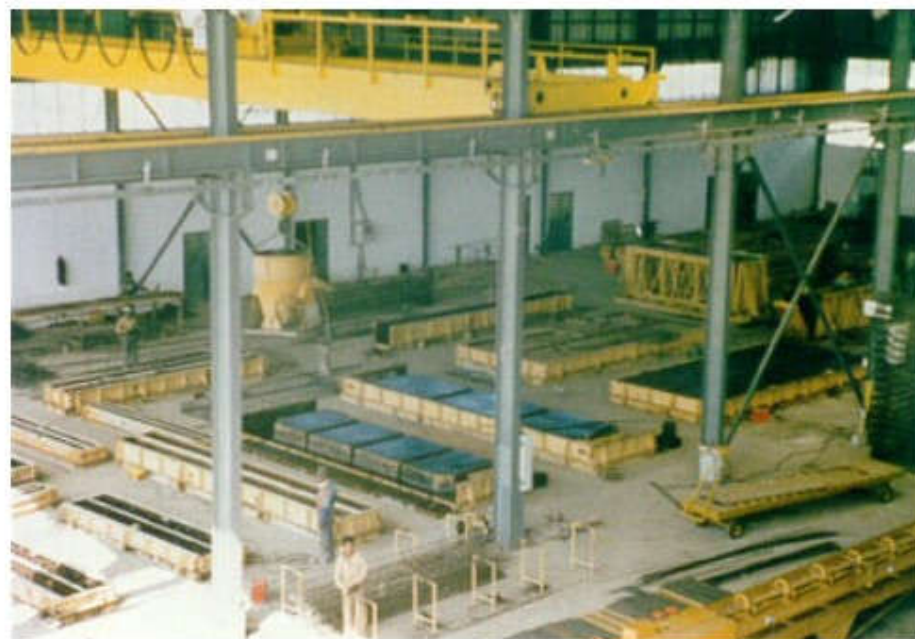
Proizvodnja IMS elemenata na otvorenim pogonima (gore) i u halama (dolje – “tvornice staniova”)
