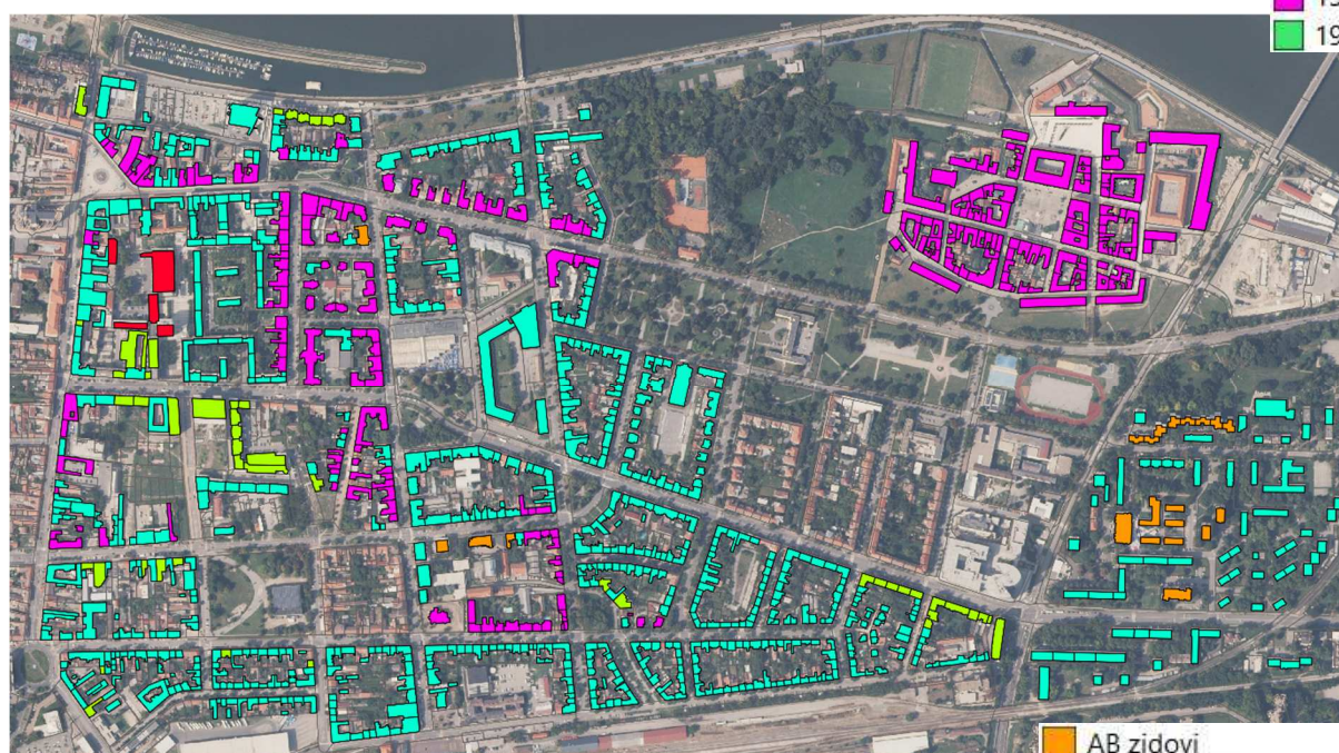
e) zgrade razvrstane prema materijalu zidova
