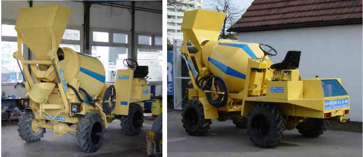
Najmanji tip – s bubnjem efektivne zapremnine 800l
