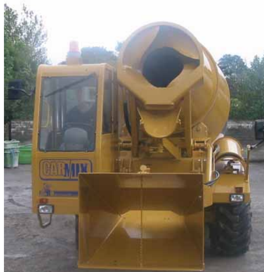
Najmanji tip – s bubnjem efektivne zapremnine 800l
