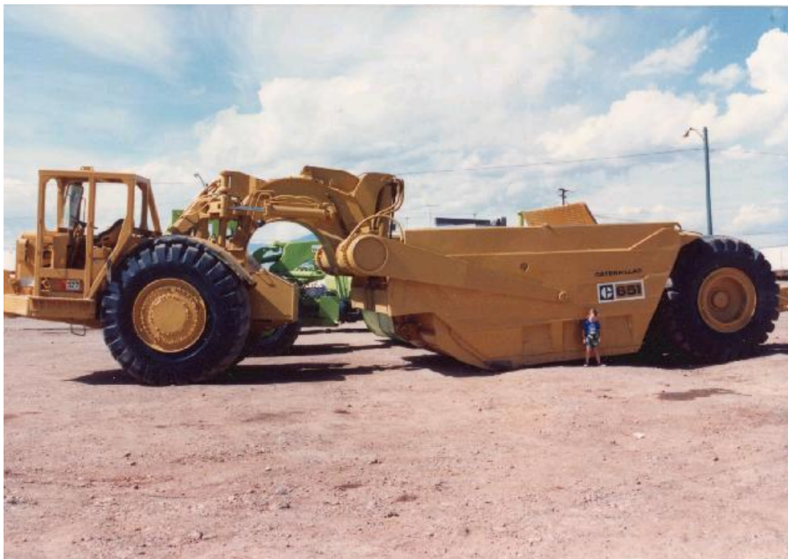
Slika 1. –Moćni suvremeni skrejper (Caterpillar651-open-bowl)
