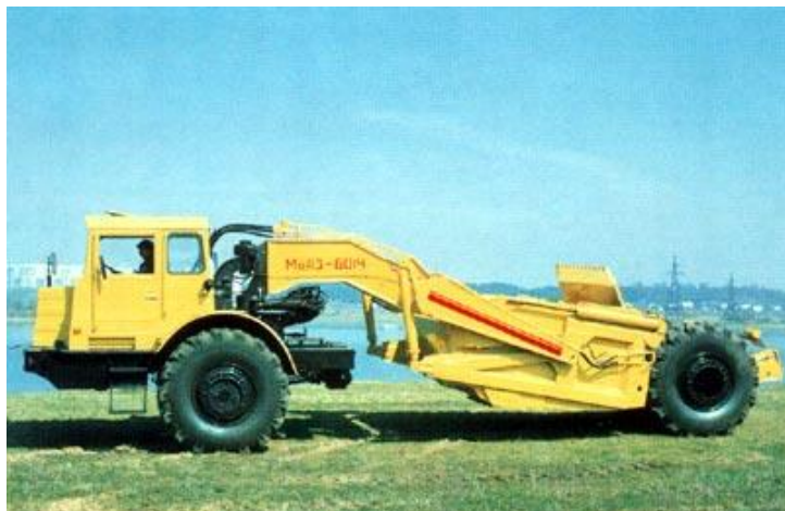
Slika 7. –Suvremeni ruski skrejper -MoAZ6014 (11 m 3 sanduk, max. brzina 44 km/h)
