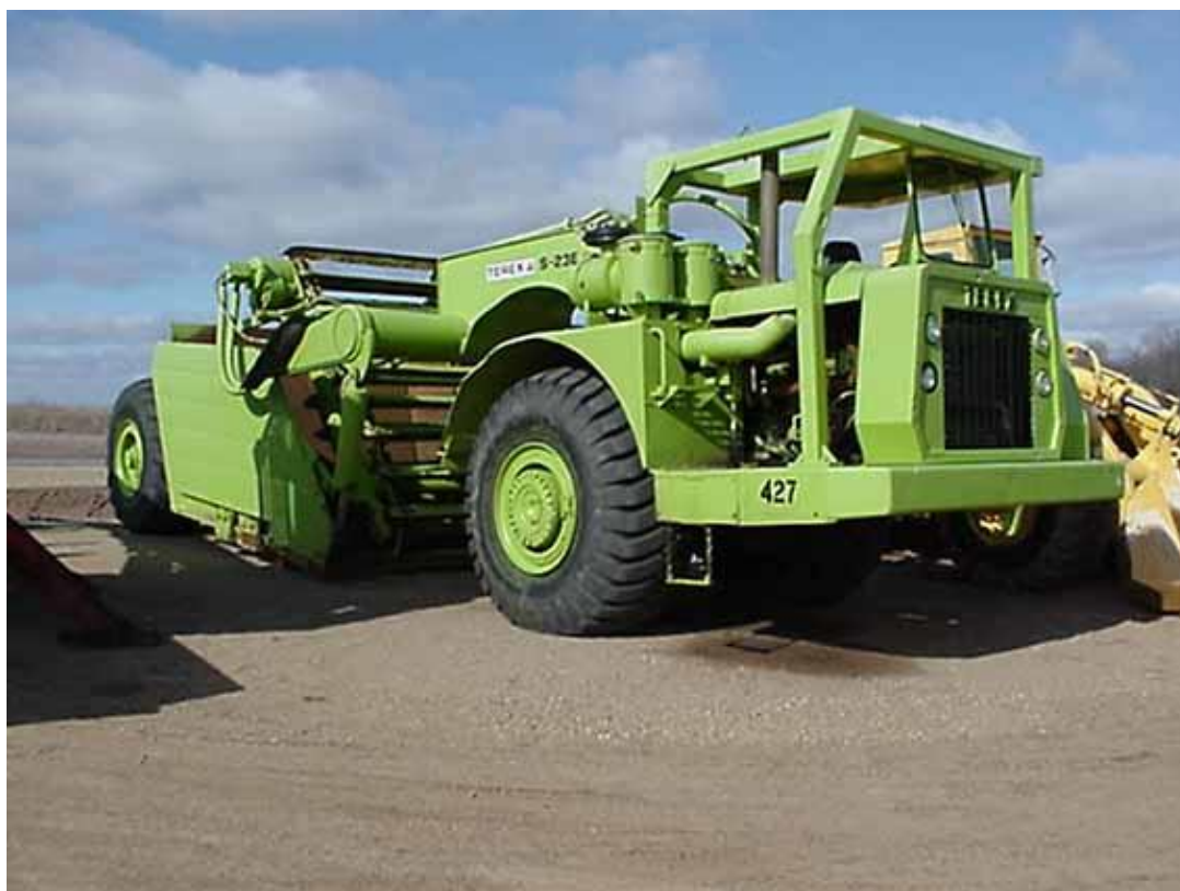
Slika 2. –Samohodni skrejper s elevatorom (TerexS23-elevating)
