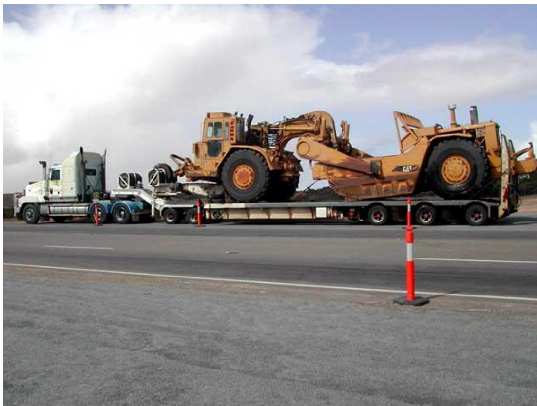
Slika 12. –Prijevoz velikog skrejpera specijalnim transporterom
