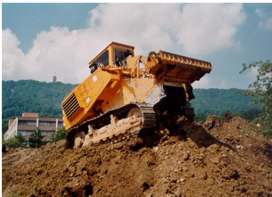
Slika 8. –Dozer skrejper s otvorenim sandukom
