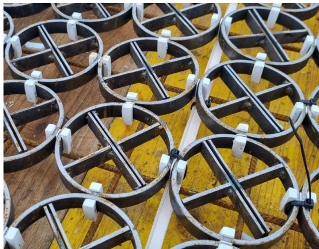
Slika 9. Prikaz sustava meta materijala zajedno s kopčama
