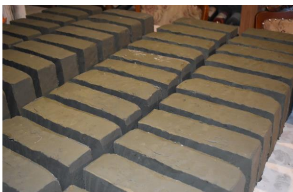
Slika 14. Proces sušenja kompozitne opeke
