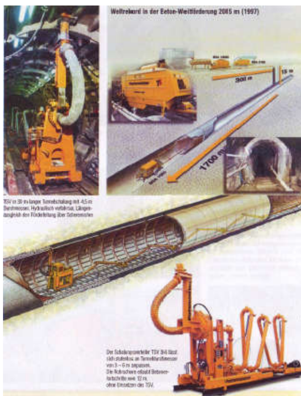
Slika br 40. BSA 2100 sa oplatnim razdjelnikom betona
