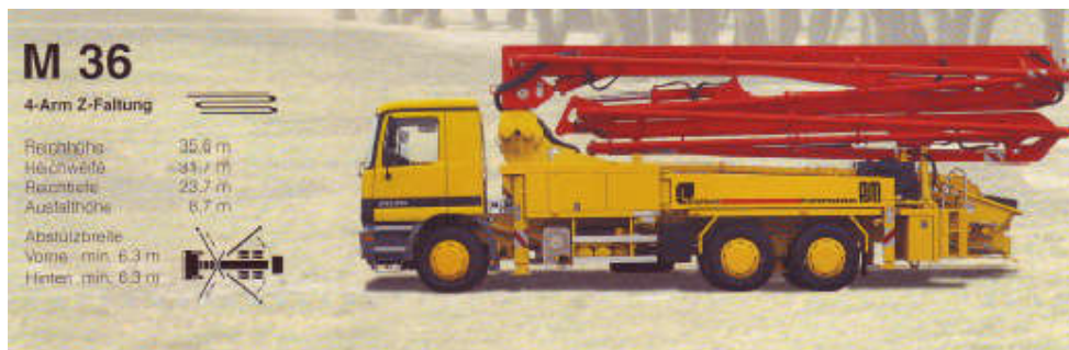
Slika br. 26. „Z“ kran
