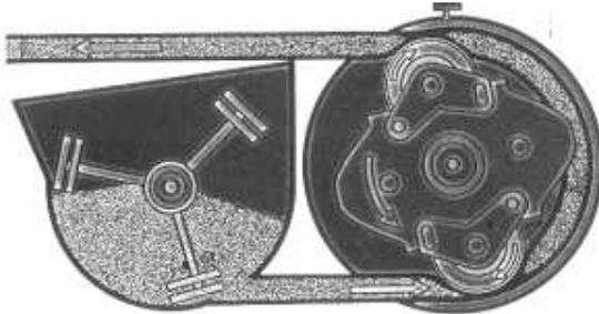
**rotacijske crpke za beton
