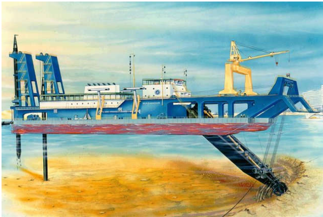
Rad na kanalu s usisnim bagerima (refulerima)
