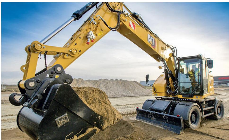
Sustav SmartBoom djelomično automatizira rad ruke rovokopača i omogućava operateru da se koncentriра na rad upravljačkom palicom
