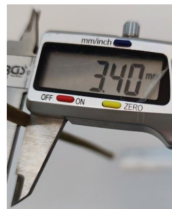
Slika 2.8 Mjerenje promjera stabljike industrijske konoplje pomoću digitalnog pomičnog mjerila
