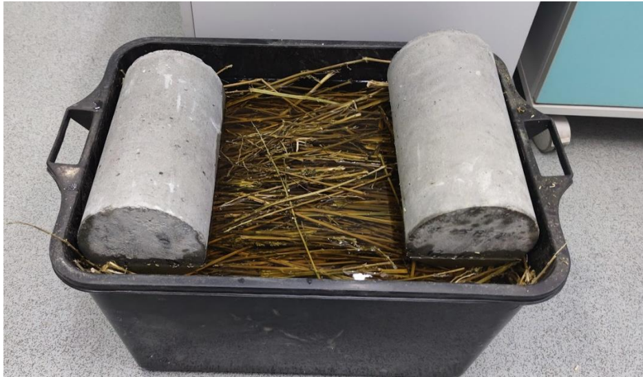
Slika 2.14 Močenje stabljike konoplje u toploj vodi
