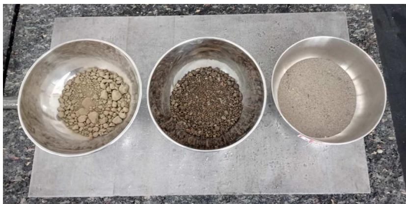
Slika 7.1 Određivanje vlažnosti u osnovnom materijalu (zemlji), dravskom pijesku i sitnom šljunki (s lijeva na desno), na uzorcima od 100 g
