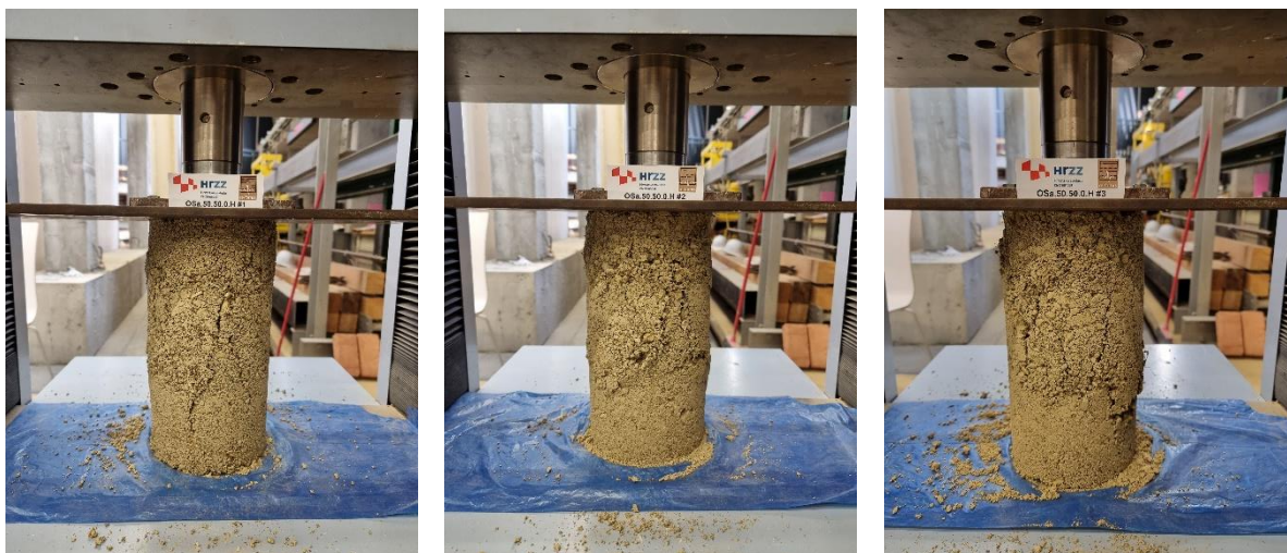
a) b) c) Slika 6.94 Ispitivanje tlačne čvrstoće na valjcima - OSa.50.50.0.H
