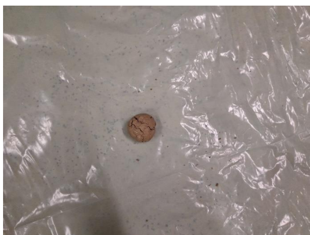
Slika 6.6 Treći slučaj - optimalna vlažnost
