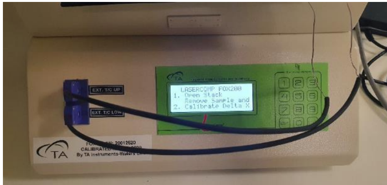
Slika 9.30 Digitalni zaslon i tipkovnica na uređaju FOX200 s upitom o oslobađanju uzorka i ponovnoj kalibraciji uređaja
