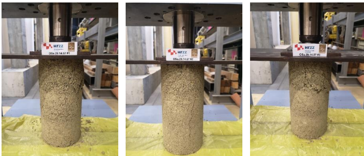
a) b) c) Slika 6.46 Ispitivanje tlačne čvrstoće na valjcima - OSa.29.14.57
