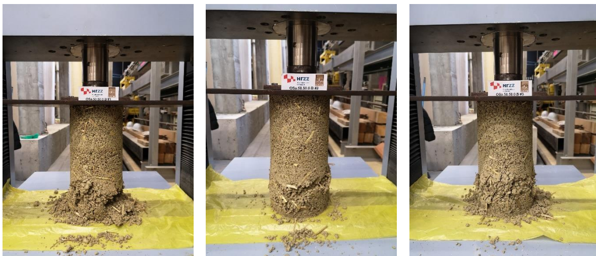
a) b) c) Slika 6.70 Ispitivanje tlačne čvrstoće na valjcima - OSa.50.50.0.B
