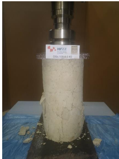
Slika 6.9 Ispitivanje tlačne čvrstoće na kockama - OSa.100.0.0
