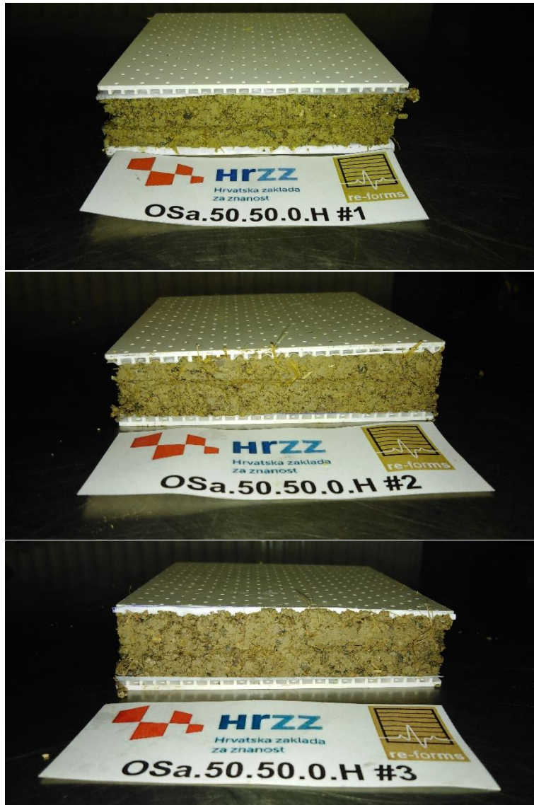
Slika 0.15 Uzorci Osa.50.50.0.H nakon ispitivanja
