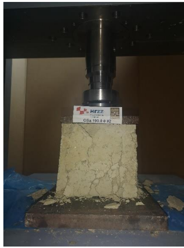
Slika 6.9 Ispitivanje tlačne čvrstoće na kockama - OSa.100.0.0
