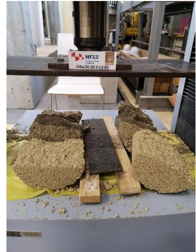
Slika 6.58 Ispitivanje tlačne čvrstoće na valjcima - OSa.50.50.0.L4
