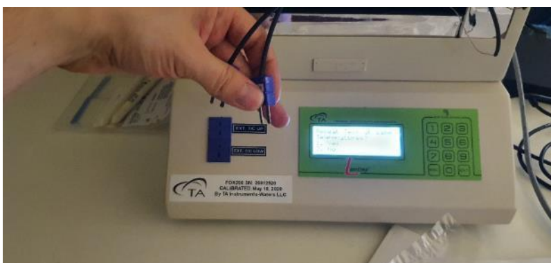
Slika 9.5 Prikaz krajeva termoparova za spajanje na uređaj FOX200
