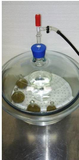
Slika 5.1 Ispitivanje gustoće čvrstih čestica s vakuumskim eksikatorom
