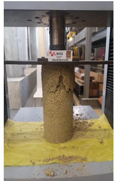
Slika 6.58 Ispitivanje tlačne čvrstoće na valjcima - OSa.50.50.0.L4
