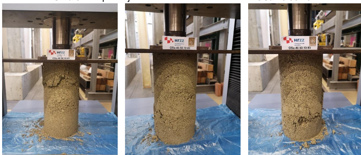
a) b) c) Slika 6.28 Ispitivanje tlačne čvrstoće na valjcima - OSa.40.50.10
