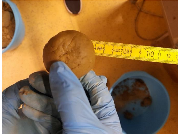
Slika 6.2 Kugla pripremljena za provedbu "drop testa"
