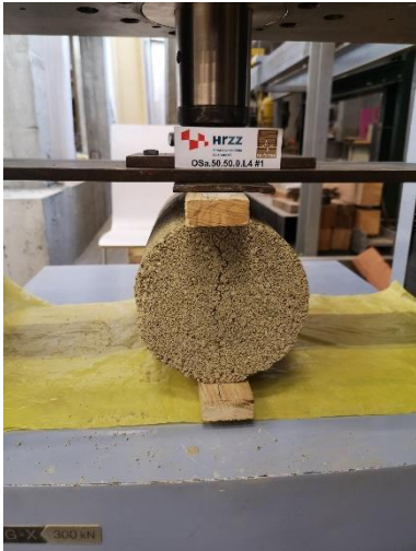
Slika 6.58 Ispitivanje tlačne čvrstoće na valjcima - OSa.50.50.0.L4
