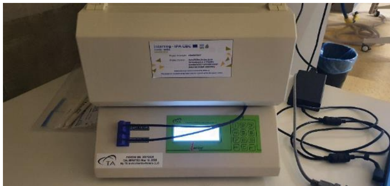
Slika 9.28 Stanje na uređaju FOX200 pri završetku ispitivanja
