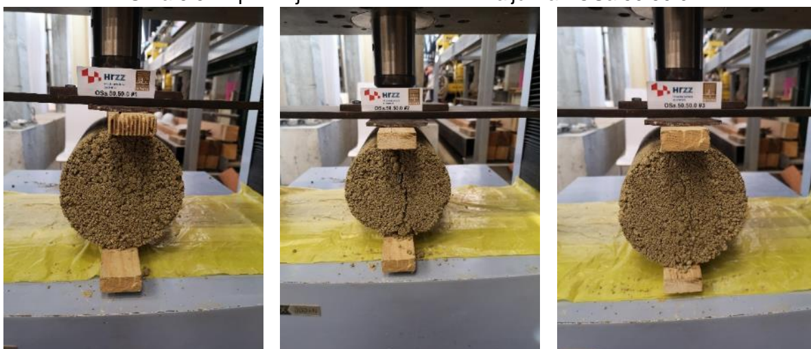
a) b) c) Slika 6.53 Ispitivanje vlačne čvrstoće na valjcima - OSa.50.50.0
