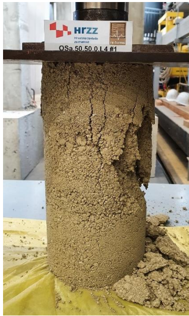
Slika 6.58 Ispitivanje tlačne čvrstoće na valjcima - OSa.50.50.0.L4
