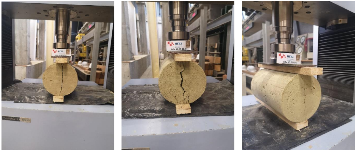
a) b) c) Slika 6.17 Ispitivanje vlačne čvrstoće na valjcima - OSa.40.20.40
