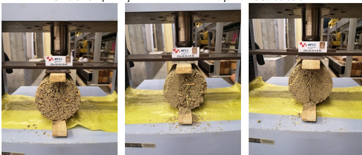
a) b) c) Slika 6.71 Ispitivanje vlačne čvrstoće na valjcima - OSa.50.50.0.B
