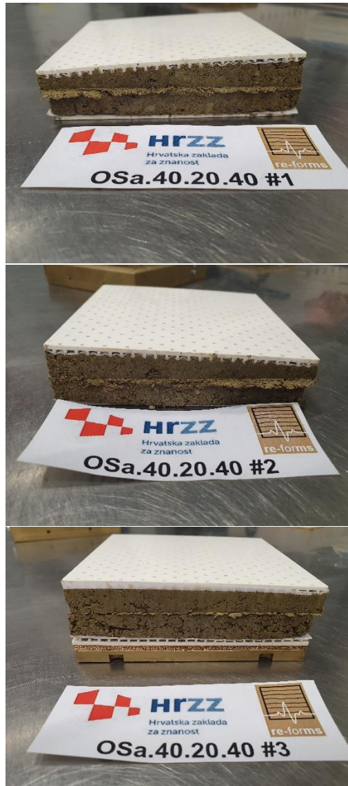
Slika 0.2 Uzorci Osa.40.20.40 nakon ispitivanja
