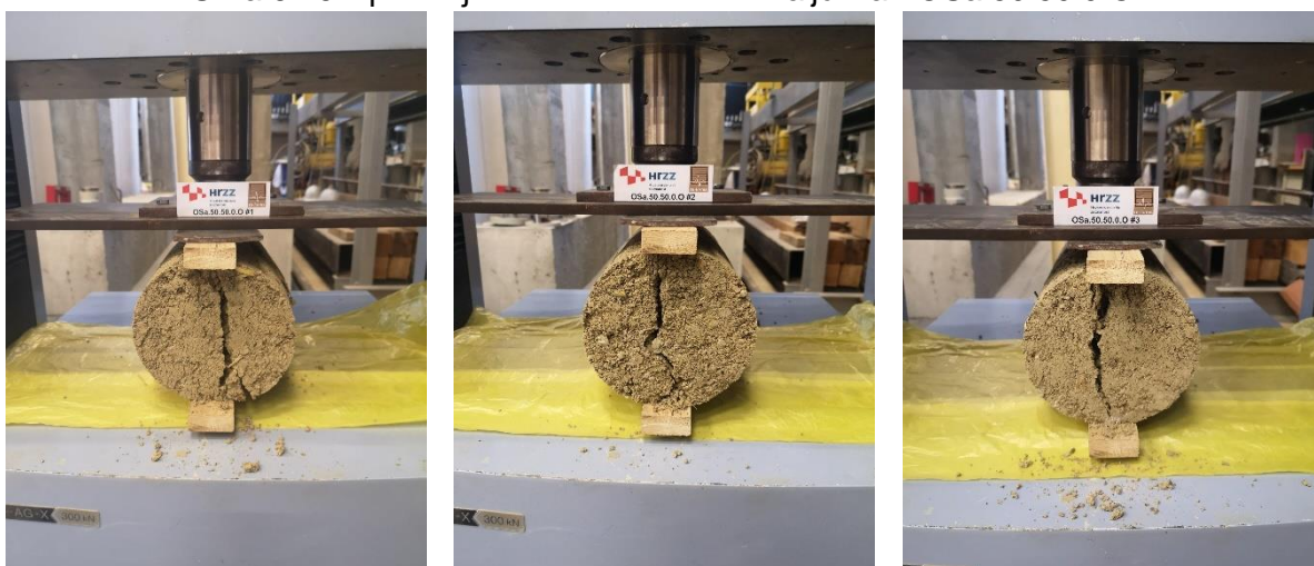
a) b) c) Slika 6.77 Ispitivanje vlačne čvrstoće na valjcima - OSa.50.50.0.0
