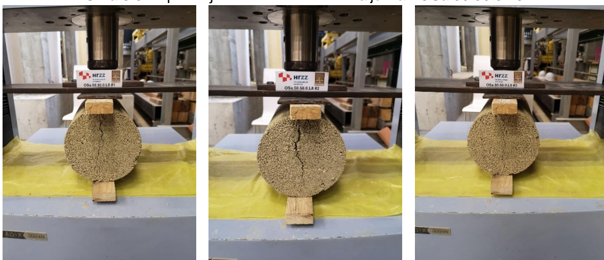
a) b) c) Slika 6.65 Ispitivanje vlačne čvrstoće na valjcima - OSa.50.50.0.L8
