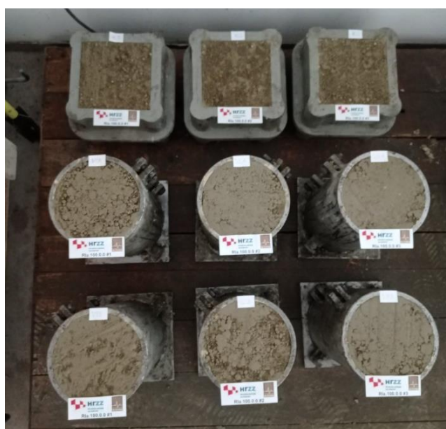
Slika 7.4 Uzorci u kalupima od zemljane mješavine Rla.100.0.0
