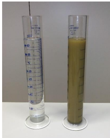
Slika 3.2 Ispitivanje granulometrijskog sastava tla areometriranjem
