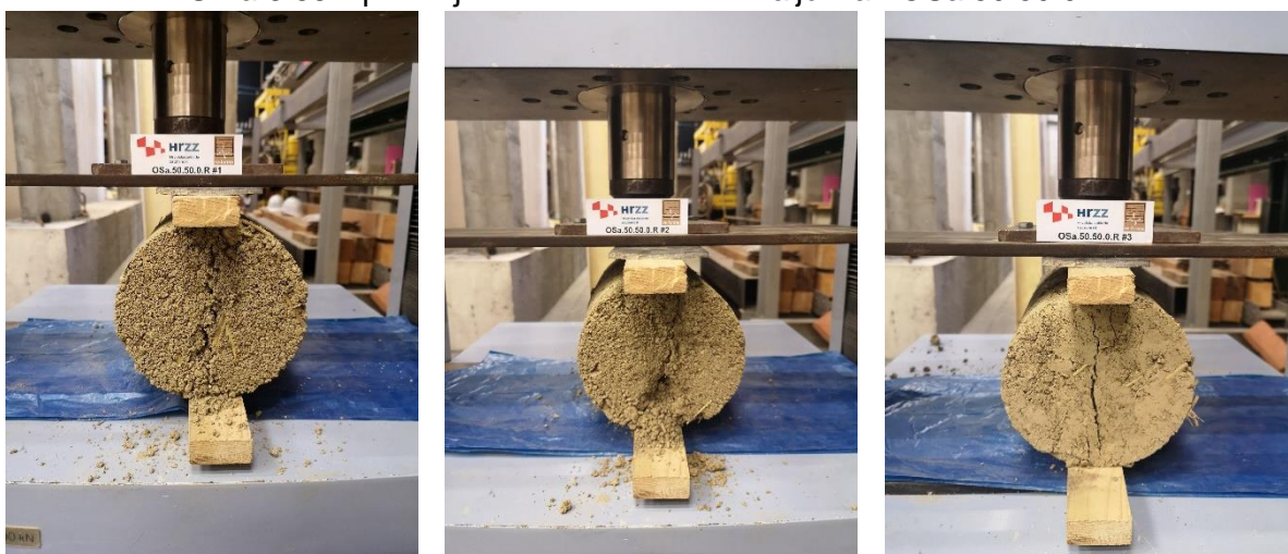
a) b) c) Slika 6.89 Ispitivanje vlačne čvrstoće na valjcima - OSa.50.50.0.R
