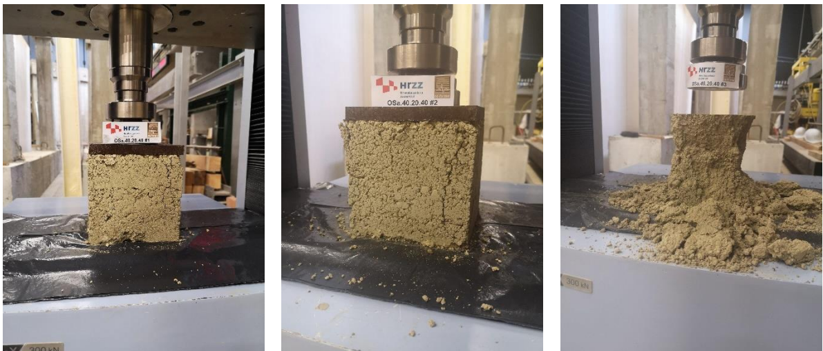
a) b) c) Slika 6.15 Ispitivanje tlačne čvrstoće na kockama - OSa.40.20.40
