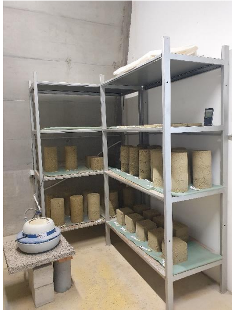
Slika 1.2 Uzorci za ispitivanje čvrstoće nabijene zemlje tijekom njegovanja u kontroliranim uvjetima (2)
