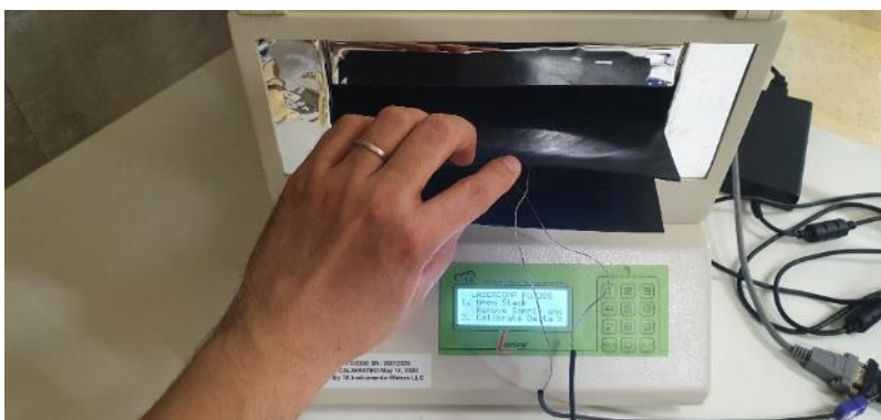
Slika 9.4 Smještanje ispitnog uzorka u uređaj FOX200
