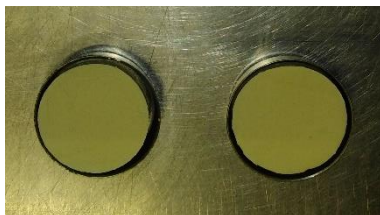
Slika 4.4 Uzorci za ispitivanje granice skupljanja nakon sušenja u sušioniku
