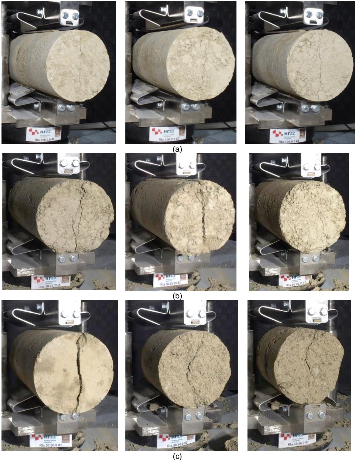
Slika 7.14 Oblik sloma uzorka valjka cijepanjem za zemljanu mješavinu (a) R1a.100.0.0, (b) R1a.50.25.25, (c) 50.50.0
