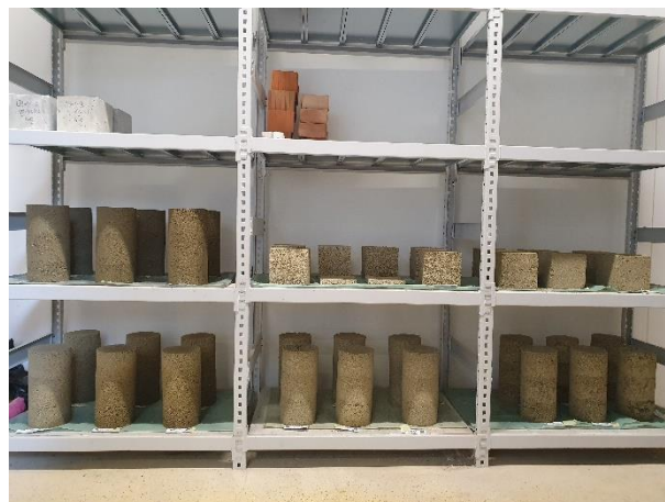
Slika 1.1 Uzorci za ispitivanje čvrstoće nabijene zemlje tijekom njegovanja u kontroliranim uvjetima (1)
