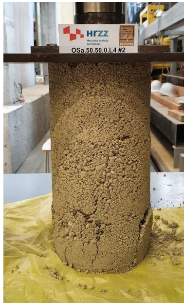
Slika 6.58 Ispitivanje tlačne čvrstoće na valjcima - OSa.50.50.0.L4
