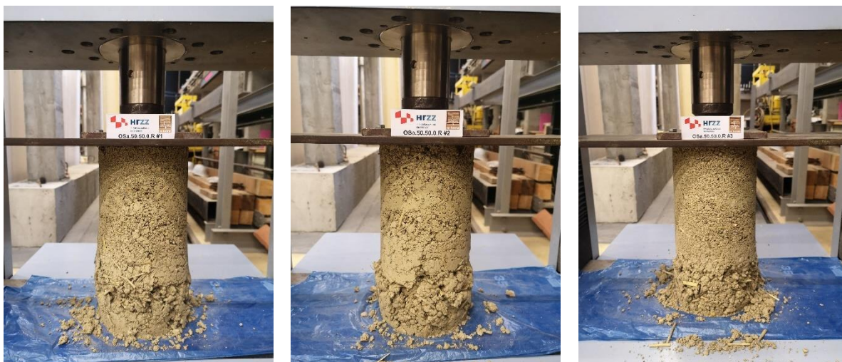
a) b) c) Slika 6.88 Ispitivanje tlačne čvrstoće na valjcima - OSa.50.50.0.R
