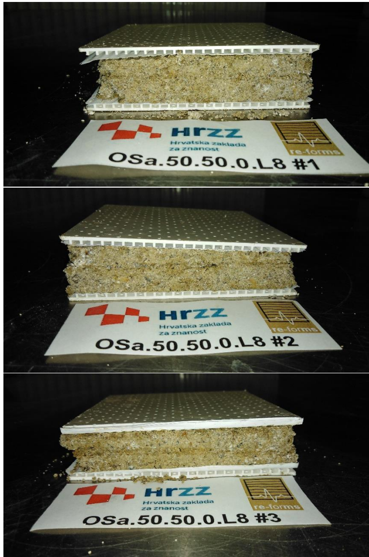
Slika 0.10 Uzorci Osa.50.50.0.L8 nakon ispitivanja
