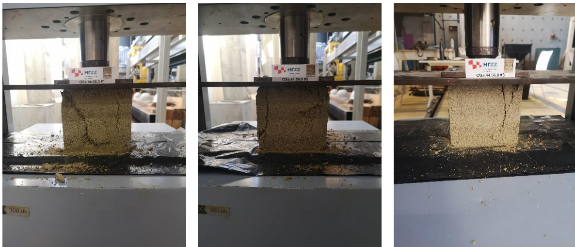
a) b) c) Slika 6.21 Ispitivanje tlačne čvrstoće na kockama - OSa.44.56.0
