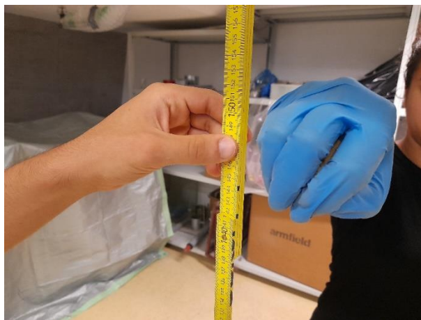
Slika 6.3 Ispuštanje kugle od zemljanog materijala s visine 150 cm
