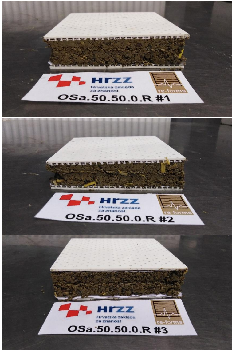
Slika 0.14 Uzorci Osa.50.50.0.R nakon ispitivanja
