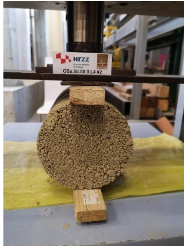
Slika 6.58 Ispitivanje tlačne čvrstoće na valjcima - OSa.50.50.0.L4
