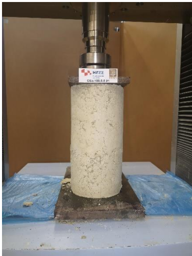
Slika 6.9 Ispitivanje tlačne čvrstoće na kockama - OSa.100.0.0
