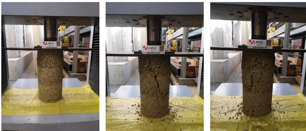
a) b) c) Slika 6.34 Ispitivanje tlačne čvrstoće na valjcima - OSa.48.48.4
