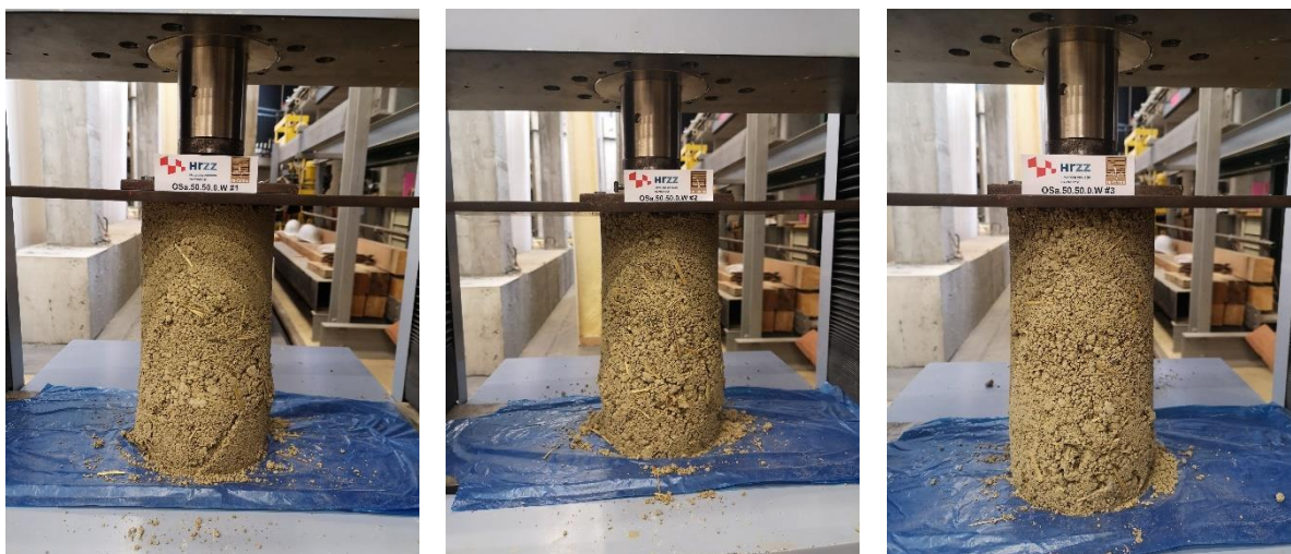
a) b) c) Slika 6.82 Ispitivanje tlačne čvrstoće na valjcima - OSa.50.50.0.W
