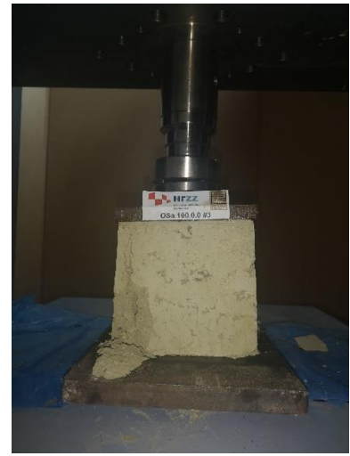
Slika 6.9 Ispitivanje tlačne čvrstoće na kockama - OSa.100.0.0
