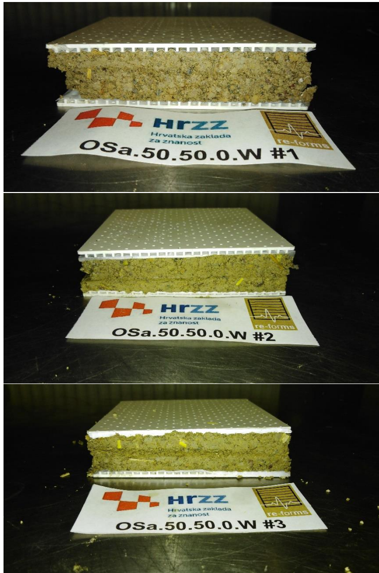
Slika 0.13 Uzorci Osa.50.50.0.W nakon ispitivanja
