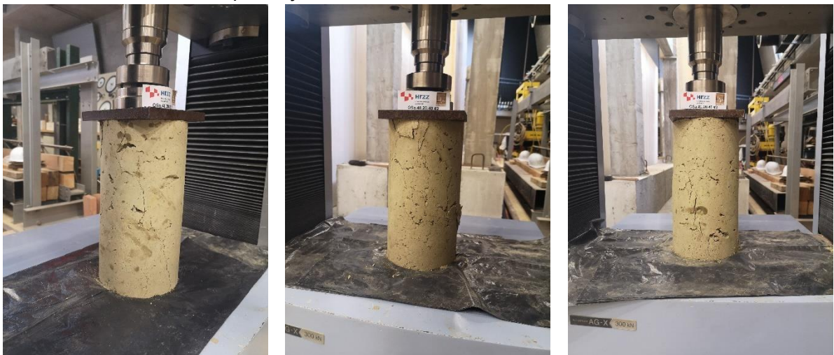
a) b) c) Slika 6.16 Ispitivanje tlačne čvrstoće na valjcima - OSa.40.20.40
