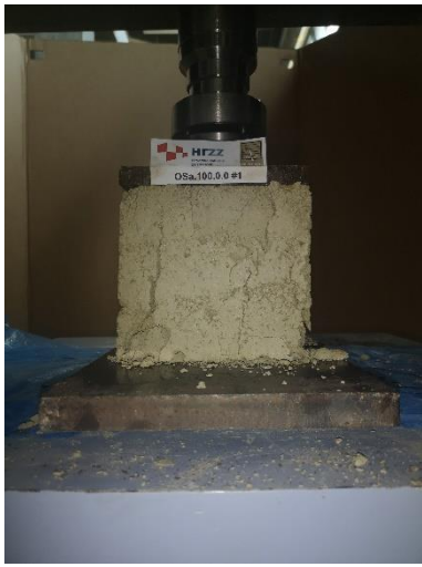
Slika 6.9 Ispitivanje tlačne čvrstoće na kockama - OSa.100.0.0
