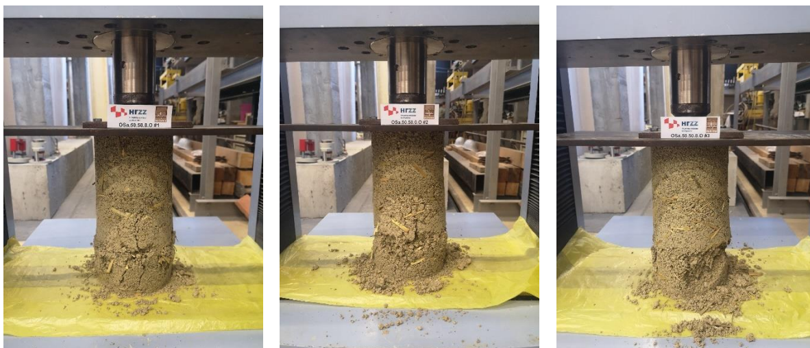
a) b) c) Slika 6.76 Ispitivanje tlačne čvrstoće na valjcima - OSa.50.50.0.0
