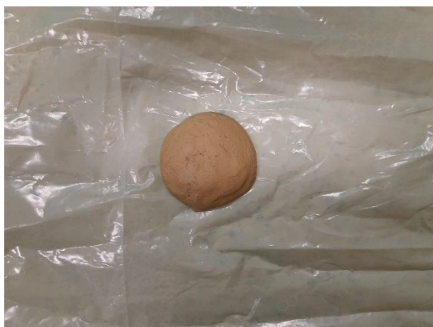
Slika 6.7 Četvrti slučaj - prevelika vlažnost
