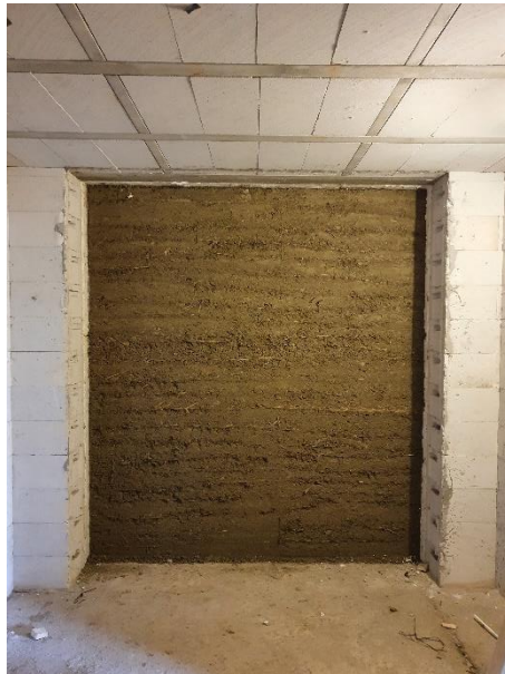
Slika 2.11 Konačni izgled zida od nabijene zemlje u komori za ispitivanje zrakopropusnosti
