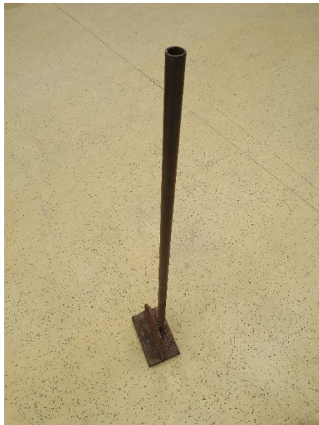
Slika 2.7 Metalni nabijač korišten prilikom izrade zemljanih zidova
