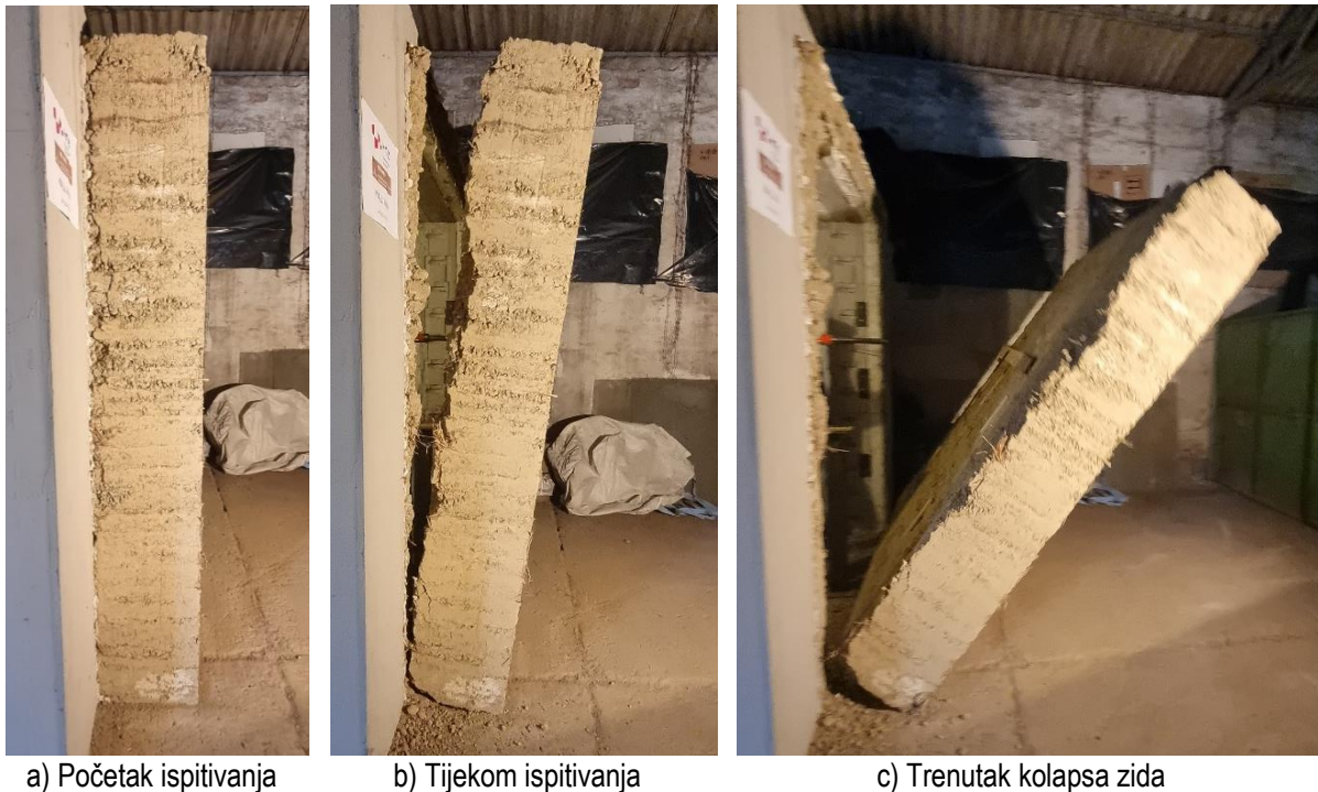
Slika 3.6 Pogled na zid W-40 tijekom ispitivanja
