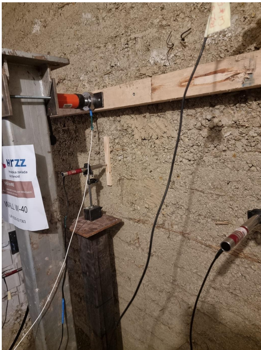
Slika 3.2 Prikaz unosa linijskog opterećenja okomito na ravninu zida od nabijene zemlje
