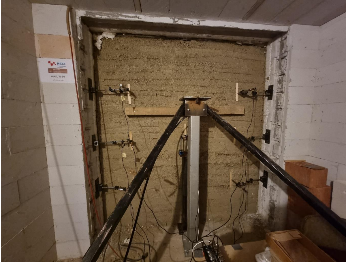
Slika 3.1 Zidovi od nabijene zemlje prije ispitivanja s postavljenim mjernim instrumentima: a) Zid W-40 s postavljenom opremom za ispitivanje, b) Zid W-50 s postavljenom opremom za ispitivanje
