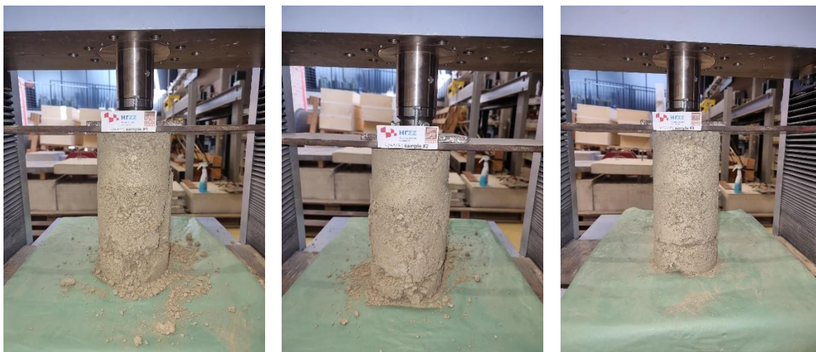
a) b) c) Slika 3.12 Ispitivanje tlačne čvrstoće na valjcima – W-40 i W-50
