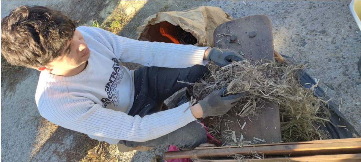
Slika 2.4 Izdvajanje vlakna industrijske konoplje na drvenoj trlici
