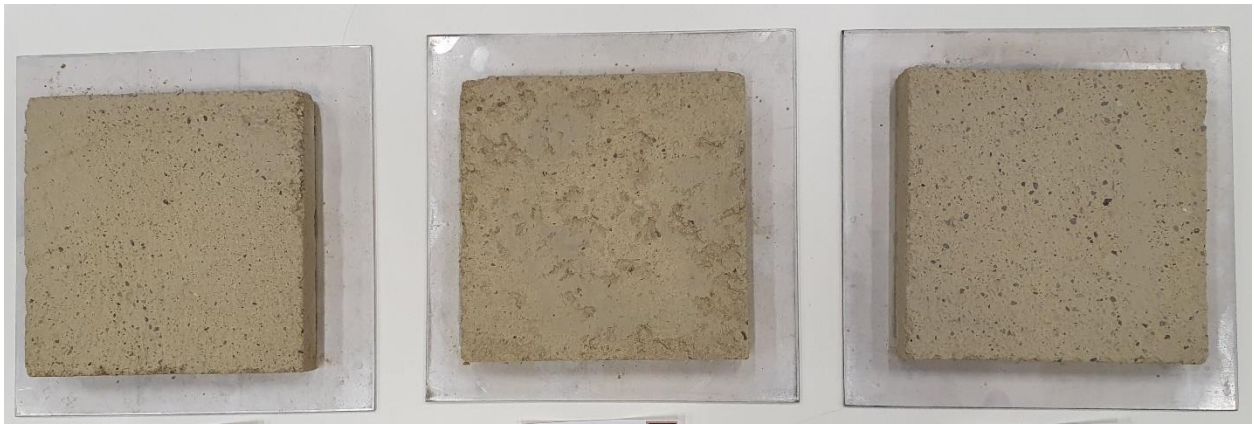
Slika 5.3 Uzorci nakon određivanja koeficijenta toplinske provodljivosti - reprezentativni uzorci izgrađenih zidova (60V+40T+4vap)
