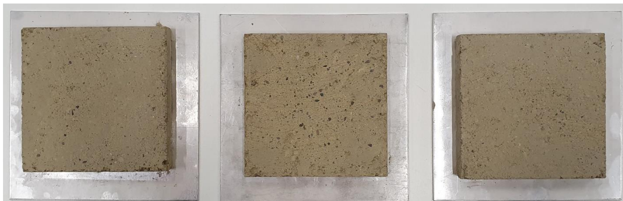
Slika 5.2 Uzorci nakon određivanja koeficijenta toplinske provodljivosti - reprezentativni uzorci izgrađenih zidova (W3)
