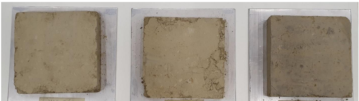
Slika 5.5 Uzorci nakon određivanja koeficijenta toplinske provodljivosti - reprezentativni uzorci izgrađenih zidova (W5-IP)
