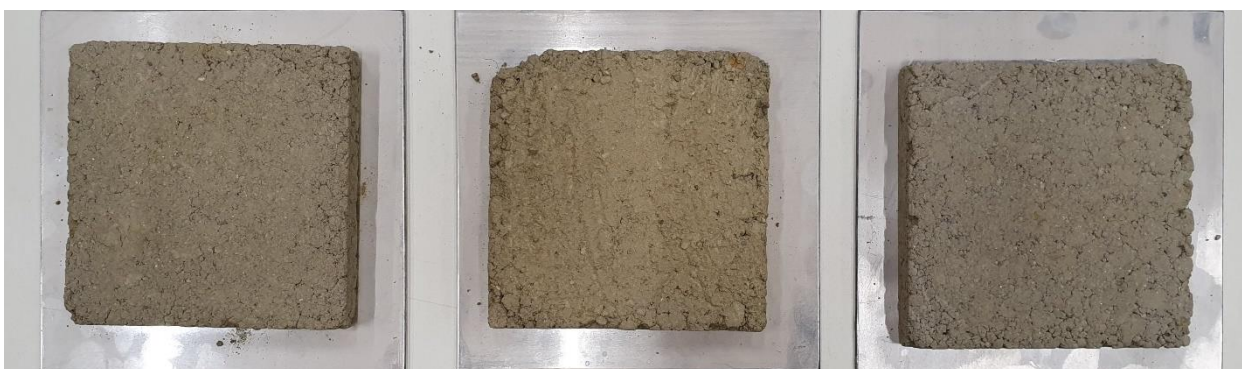
Slika 5.7 Uzorci nakon određivanja koeficijenta toplinske provodljivosti - reprezentativni uzorci izgrađenih zidova (M3_10_11)
