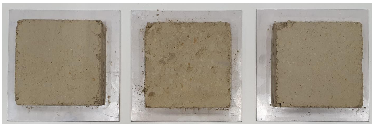
Slika 5.1 Uzorci nakon određivanja koeficijenta toplinske provodljivosti - reprezentativni uzorci izgrađenih zidova (W1)
