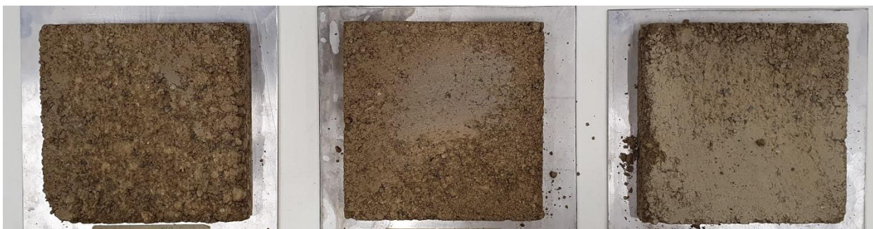
Slika 5.6 Uzorci nakon određivanja koeficijenta toplinske provodljivosti - reprezentativni uzorci izgrađenih zidova (W6-IP)
