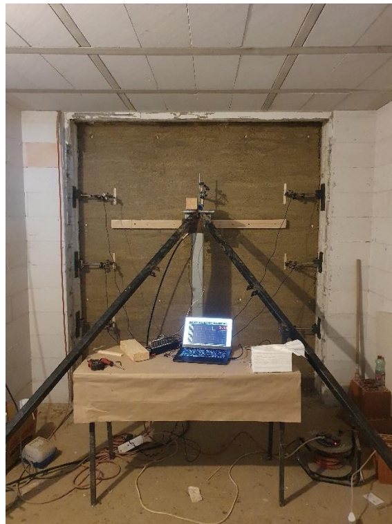
Slika 2.1 Prikaz unosa opterećenja okomito na ravninu zida
