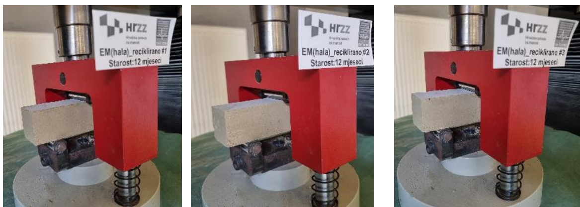
a) b) c) Slika F.3 Ispitivanje vlačne čvrstoće na savijanje na prizmama - reciklirani materijal
