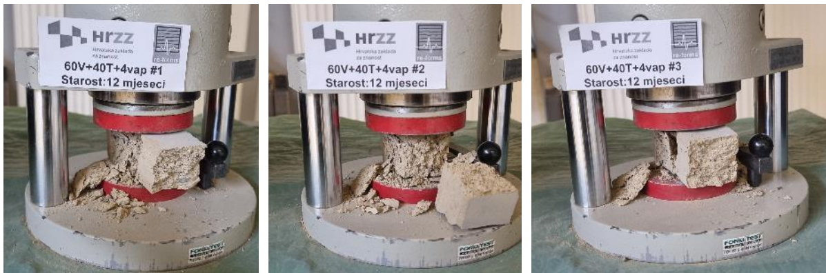
Slika C.4 Ispitivanje tlačne čvrstoće na prizmama - 60/40 + 4 % vapno
