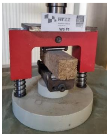
Slika 0.13 Ispitivanje vlačne čvrstoće na savijanje na prizmama – W6
