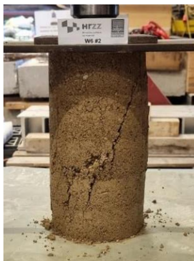
Slika 0.12 Ispitivanje tlačne čvrstoće na valjcima – W6
