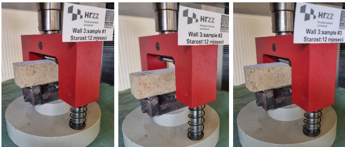
Slika B.3 Ispitivanje vlačne čvrstoće na savijanje na prizmama - W3/W4
