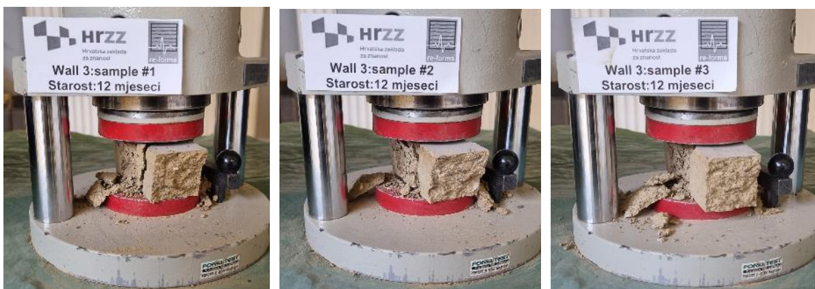
Slika B.3 Ispitivanje vlačne čvrstoće na savijanje na prizmama - W3/W4
