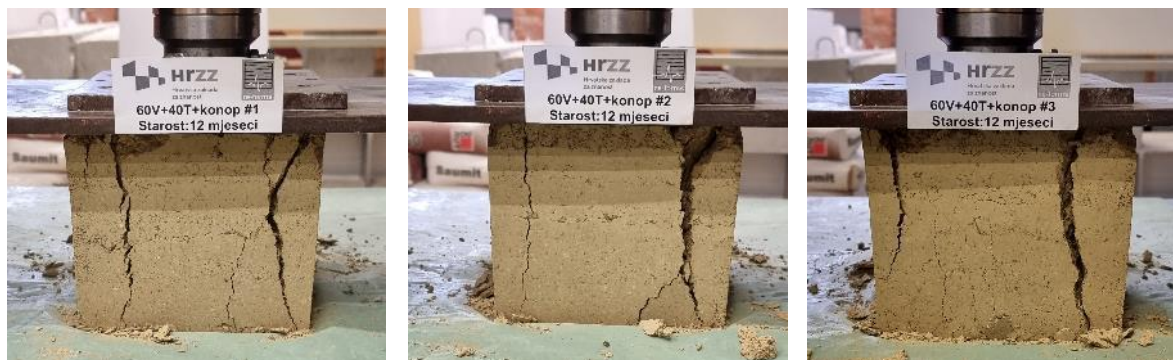
Slika D.1 Ispitivanje tlačne čvrstoće na kockama – 60/40 + industrijska konoplja
