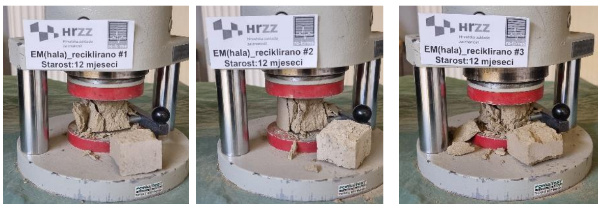
a) b) c) Slika F.4 Ispitivanje tlačne čvrstoće na prizmama - reciklirani materijal
