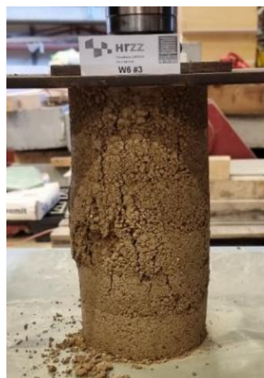
Slika 0.12 Ispitivanje tlačne čvrstoće na valjcima – W6
