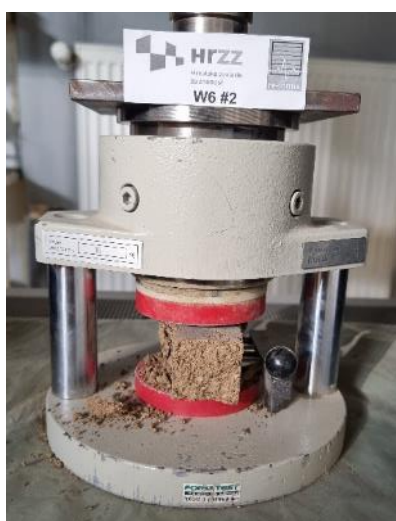
Slika 0.14 Ispitivanje tlačne čvrstoće na prizmama – W6
