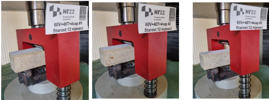
Slika C.3 Ispitivanje vlačne čvrstoće na savijanje na prizmama - 60/40 + 4 % vapno
