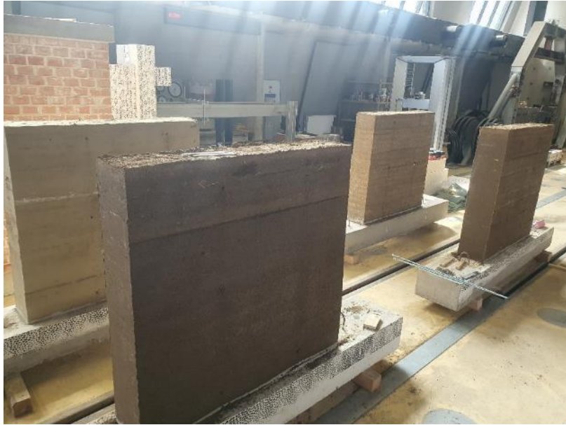
Slika 0.7 Modeli zidova par dana nakon uklanjanja oplata
