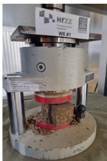
Slika 0.14 Ispitivanje tlačne čvrstoće na prizmama – W6
