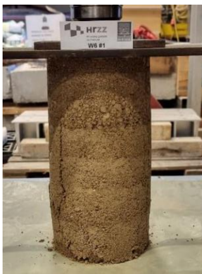
Slika 0.12 Ispitivanje tlačne čvrstoće na valjcima – W6
