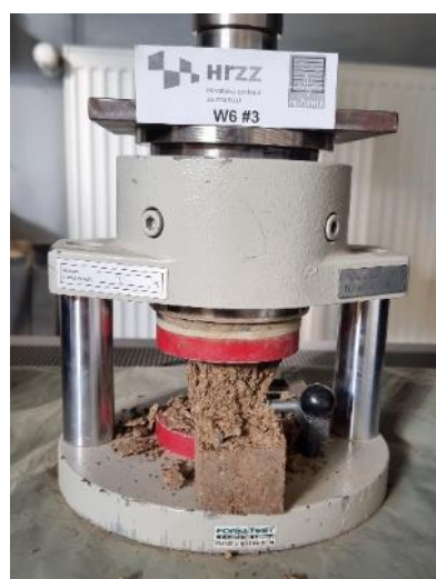
Slika 0.14 Ispitivanje tlačne čvrstoće na prizmama – W6
