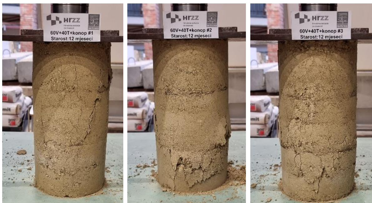
Slika D.1 Ispitivanje tlačne čvrstoće na kockama – 60/40 + industrijska konoplja
