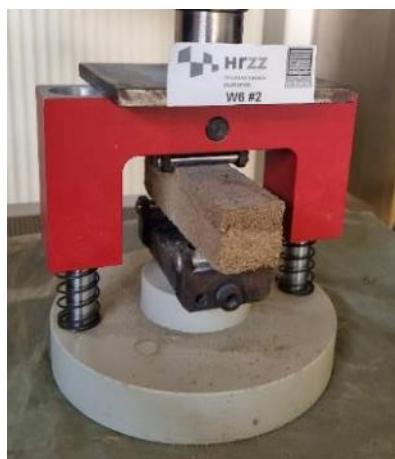
Slika 0.13 Ispitivanje vlačne čvrstoće na savijanje na prizmama – W6
