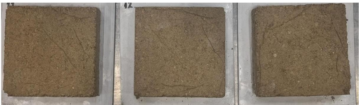
Slika 3.6 Uzorci nakon određivanja koeficijenta toplinske provodljivosti – materijal za zidove W9-W12
