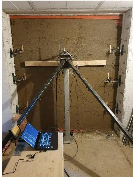
Slika 2.1 Zid od nabijene zemlje prije ispitivanja s postavljenim mjernim instrumentima
