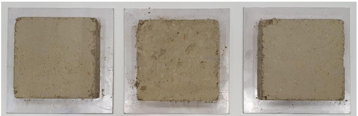
Slika 3.4 Uzorci nakon određivanja koeficijenta toplinske provodljivosti - reprezentativni uzorci izgrađenih zidova
