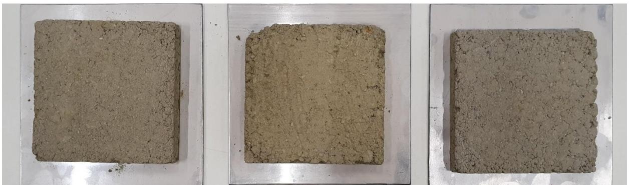
Slika 3.3 Uzorci nakon određivanja koeficijenta toplinske provodljivosti - reprezentativni uzorci izgrađenih zidova
