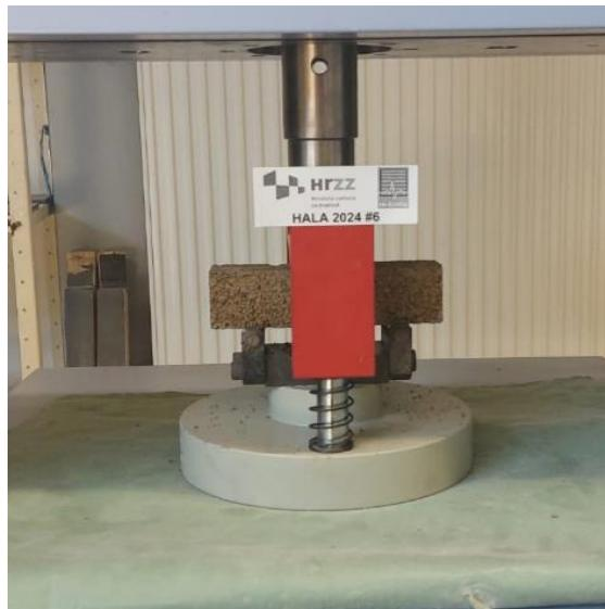
Slika 4.3.1 Ispitivanje vlačne čvrstoće uzorka od nabijene zemlje
