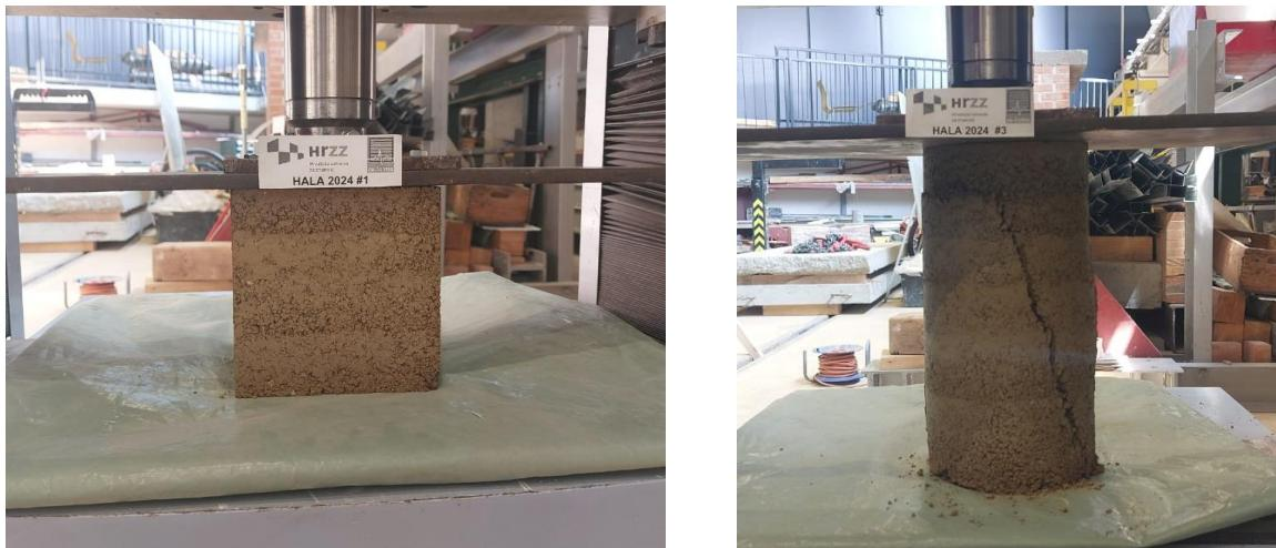
Slika 4.2.1 Uzorci na kojima je ispitivana tlačna čvrstoća: kocka dimenzija  $150 \times 150 \times 150 \text{ mm}$  (lijevo) i valjak dimenzija  $150 \times 300 \text{ mm}$  (desno)
