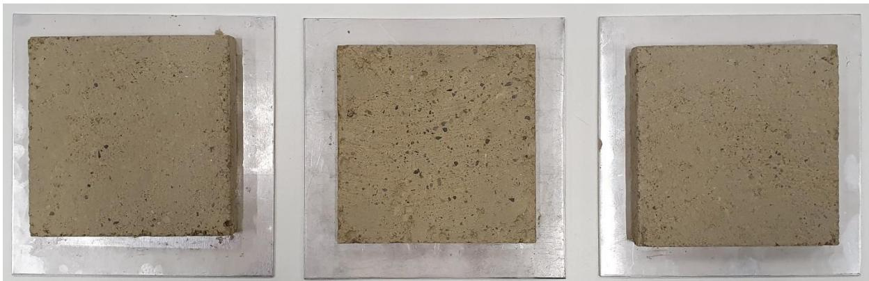
Slika 3.5 Uzorci nakon određivanja koeficijenta toplinske provodljivosti - reprezentativni uzorci izgrađenih zidova (W3)
