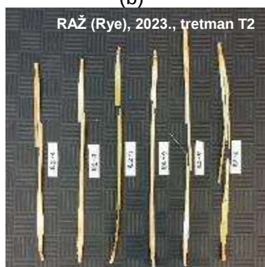
Slika 3.21 Oblik sloma uzoraka raži (R) za a) T0, b) T1, c) T2 (skinuti s njive 2023. godine)
