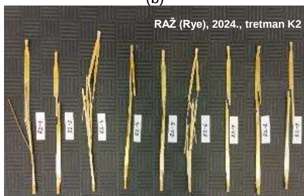
Slika 3.22 Oblik sloma uzoraka raži (R) za a) G, b) K1, c) K2 (skinuti s njive 2024. godine)
