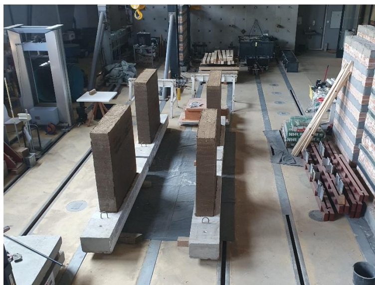
Slika 3.1 Geometrija modela zidova od nabijene zemlje
