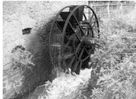
*Unterslächtiges Wasserrad in Betrieb*
