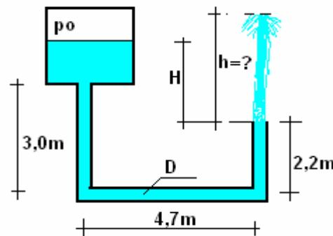
35. Odredite snagu crpke i tlak u točki A ( $p_A$ ) uz uvjet da je protok vode u cijevi konstantnog promjera  $D=150\text{mm}$  jednak  $Q=150\text{l/s}$ . Zadano:  $\xi_{ul}=0,5$ ;  $v=1,06 \times 10^{-6} \text{ m}^2/\text{s}$ ;  $\varepsilon=0,2\text{mm}$ ;  $\mu=0,7$
