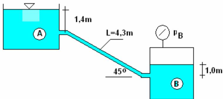
33. Voda struji od rezervoara A prema B. Odredite tlak u rezervoaru A ( $p_1$ ), ako je zadano:  $p_2=40 \text{ kPa}$ ;  $Q=0,1\text{m}^3/\text{s}$ ;  $d=150\text{mm}$ ;  $v=0,113\times10^{-5} \text{ m}^2/\text{s}$ ;  $\varepsilon=0,05\text{mm}$ ;  $\xi_{ul}=0,4$ ;  $\xi_{kolj}=0,9$ ;  $\xi_{iz}=1,0$ . Nacrtajte energetsku i pijezometarsku liniju.
