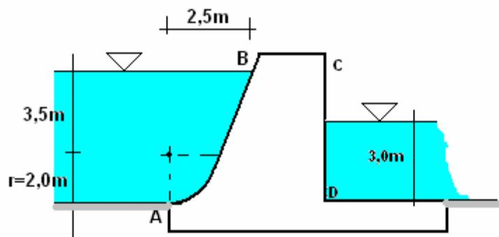
6. Odredite veličinu sile  $F$  kojom treba pridržavati konstrukciju AB jedinične širine da bi u položaju prema slici bila u ravnoteži. Konstrukcija je okretljiva oko točke A. Težinu konstrukcije zanemarite.
