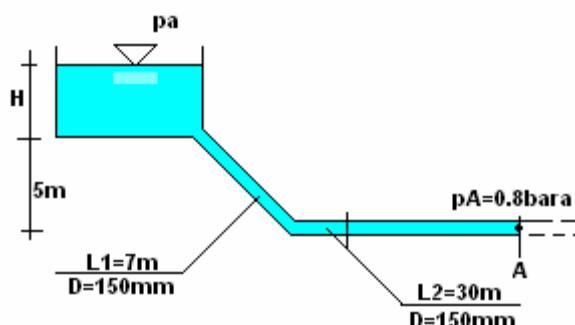
22. Odredite snagu crpke ( $P$ ) potrebnu za ostvarenje protoka  $Q=150 \text{ l/s}$  vode kroz zadani cjevovod pod uvjetom da je tlak u točki A jednak  $p_A=1 \text{ bar}$ . Zadano:  $\eta=0,7$ ;  $D=200\text{mm}$ ;  $v=1,21\times10^6 \text{ m}^2/\text{s}$ ;  $\epsilon=0,5\text{mm}$ ;  $\xi_{\text{koli}}=0,35$ . Nacrtajte pijezometarsku i energetsку liniju!
