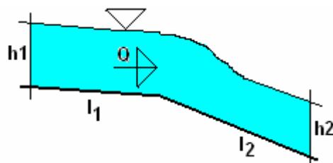
59. Na preljevu u pravokutnom koritu širine  $b=20m$ , kod visine preljevnog mlaza  $H= 2,0m$  i srednje brzine preljevanja  $v_{sr}=3,25m$ . Odredite vrijednost koeficijenta preljevanja ( $m_o$ )
