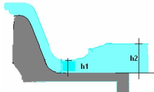
57. Odredite vrijeme potrebno za sniženje razine vode za  $\Delta h$  u rezervoaru kružnog poprečnog presjeka promjera  $D=3,0\text{m}$ . Otvor je također kružnog poprečnog presjeka promjera  $d=20\text{cm}$ . Zadano: koef.istjecanja  $\mu=0,82$ ;  $h_1= 1,8\text{m}$ ;  $h_2=0,6\text{m}$
