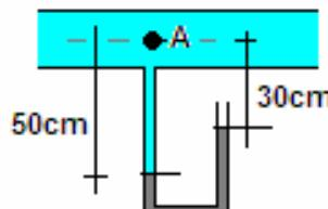
**Osnovna jednadžba hidrostatike na kontaktnom presjeku dvije kapljevine glasi:**
