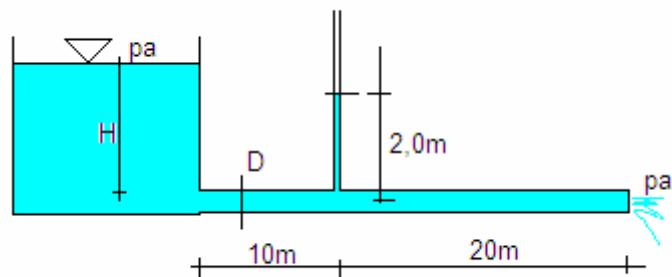
21. Odredite razinu vode u rezervoaru ( $H$ ) za dionicu cjevovoda na slici ako je protok  $Q=25 \text{ l/s}$ , a traženi tlak u točki A  $p_A = 0,8 \text{ bara}$ . Zadano:  $D_1 = 150\text{mm}$ ;  $v = 1,06 \times 10^{-6} \text{ m}^2/\text{s}$ ;  $\epsilon = 0,2\text{mm}$ ;  $\xi_{ui} = 0,35$ ;  $\xi_{kolj} = 1,35$ . Nacrtajte piyezometarsku i energetska liniju.
