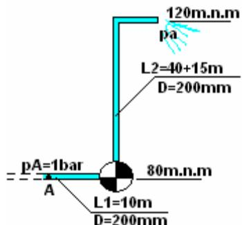
23. Zadani sustav karakteriziraju sljedeći uvjeti :  $D=120\text{mm}$ ;  $\lambda =0,0175$ ;  $v=1,02 \times 10^6 \text{ m}^2/\text{s}$ ;  $p_B=20 \text{ kPa}$ ;  $\xi_{\text{koli}}=0,65$ ;  $\xi_{\text{zat}}=5,0$ ;  $\xi_{\text{izl}}=1,0$ ;  $\rho=1000 \text{ kg/m}^3$ ;
