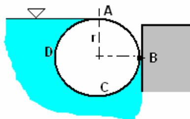
18. Odredite ukupnu silu hidrostatskog tlaka na zakrivljeni dio zida A-B. Definirajte i njezin položaj. Zadano:  $R=1,2 \text{ m}$ ;  $b=5,0 \text{ m}$ ;  $\rho_v=1000 \text{ kg/m}^3$ ;  $\rho_{\text{glic}}=1258 \text{ kg/m}^3$ .
