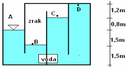
17. Odredite veličinu i smjer sumarne sile hidrostatskog tlaka koja djeluje na valjak radijusa  $r=0,6 \text{ m}$  i dužine  $b=4,0 \text{ m}$  ( $\rho_v=1000 \text{ kg/m}^3$ ).
