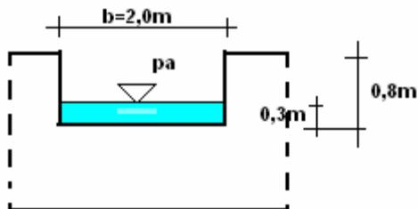
42. Ako kanalom pravokutnog poprečnog presjeka protječe  $Q= 15\text{m}^3/\text{s}$  pri padu dna  $I=0,4\%$  i koeficijentu hrapavosti  $n=0,029$ , koliki protok će se ostvariti oblaganjem kanala i smanjenjem hrapavosti na  $n=0,0,16$ .
