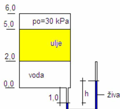
2. Odredite manometarski tlak u točki A ( $p_A$ ) za zadane uvjete:  $h_1=45\text{cm}$ ;  $h_2=5\text{cm}$ ,  $\rho_{ulje}=780 \text{ kg/m}^3$ ;  $\rho_{živa}=1250 \text{ kg/m}^3$ . Nacrtajte raspodjelu tlakova na vertikalnu stijenku posude
