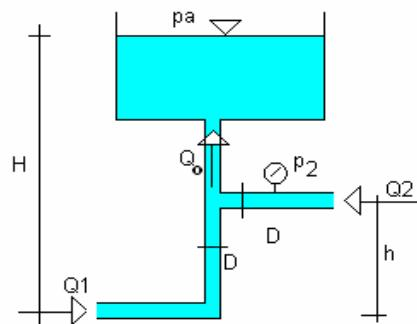
28. U sustavu na slici ostvaruje se stacionarno strujanje fluida protokom  $Q_o=154 \text{ l/s}$ . Odredite protok  $Q$  koji će se ustaliti u sustavu ako se na polovini duljine cjevovoda postojića cijev promjera  $d=300 \text{ mm}$  zamijeni s većom cijevi promjera  $D=500 \text{ mm}$  iste hraptavosti. Koeficijent gubitak na suženju  $\xi=0,5$  (uz nizvodnu brzinu), a ostale lokalne gubitke zanemariti. Zadano je:  $\rho=998 \text{ kg/m}^3$ ,  $\lambda=0,014 \text{ mm}$ ,  $L=1200 \text{ m}$ .
