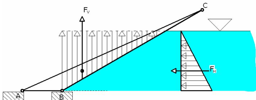
**ZAKLJUČAK:** Automatski zatvarač će se otvoriti jer je težina zatvarača manja od sile hidrostatskog tlaka koja na njega djeluje.
