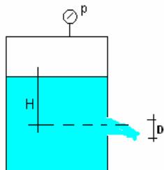
55. Kroz kružni otvor promjera  $D=8\text{ cm}$  koji se nalazi u stijenci rezervoara istječe voda. Zadano:  $H=2,0\text{m}$ ;  $v=1,06 \times 10^{-6}\text{ m}^2/\text{s}$ . Radi li se o istjecanju kroz mali ili veliki otvor? Odredite protok kroz otvor.
