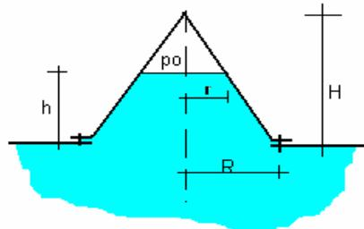
11. Odredite silu hidrostatskog tlaka na ravni i polucilindrični poklopac prema slici. Na koji poklopac djeluje veća sila? Zadatak riješiti po jediničnoj duljini. Zadano:  $H = 2,2 \text{ m}$ ,  $D = 3,0 \text{ m}$ ,  $\alpha = 45^\circ$ .
