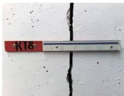
Slika 9. Ravnalo za mjerenje vertikalnih pukotina
