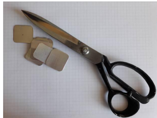
Slika 14. Blende za kameru načinjene od tankog aluminijske folije
