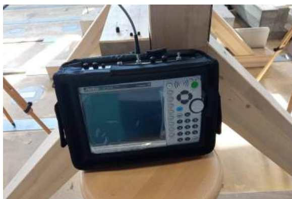
Slika 3.26: Mrežni analizator tipa Anritsu MS2038C
