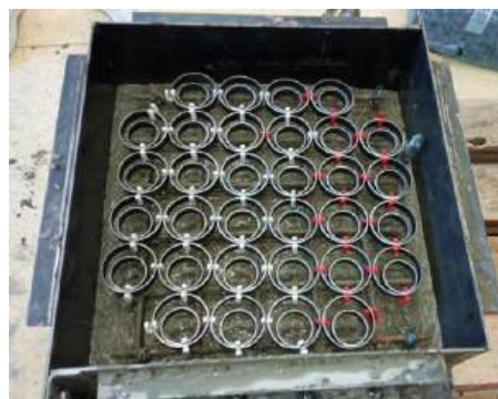
Slika 3.11: Primjer postavljanja prstenastih čeličnih mikrovalnih rezonatora
