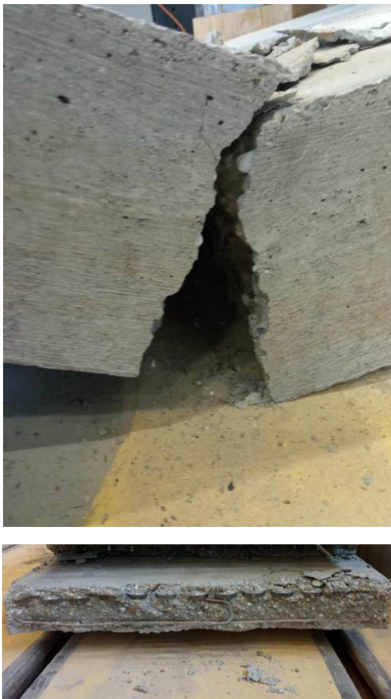
Slika 4.28: Oštećenje plošnog nosača P-P-1 tijekom opterećenja
