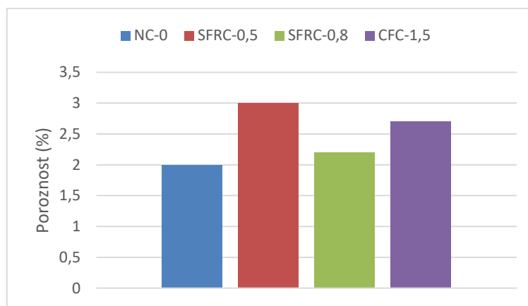
Slika 3.20: Grafički prikaz poroznosti mješavina betona
