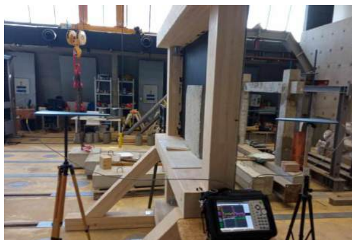
Slika 3.31: Ispitivanje uzorka plošnog nosača na prodor EM zračenja
