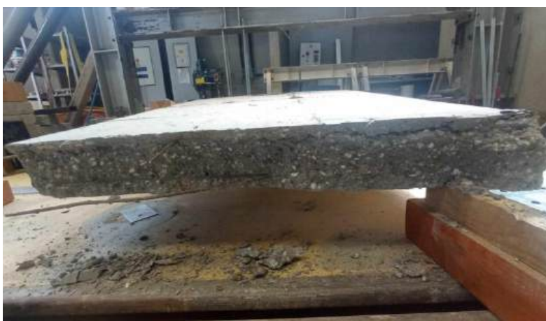
Slika 4.43: Oštećenje plošnog nosača P-K-1 tijekom opterećenja
