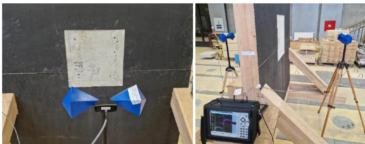
Slika 3.60: Eksperimentalno ispitivanje uzorka plošnog nosača PP2 na zaštitu od EM zračenja Bicollog antenom
