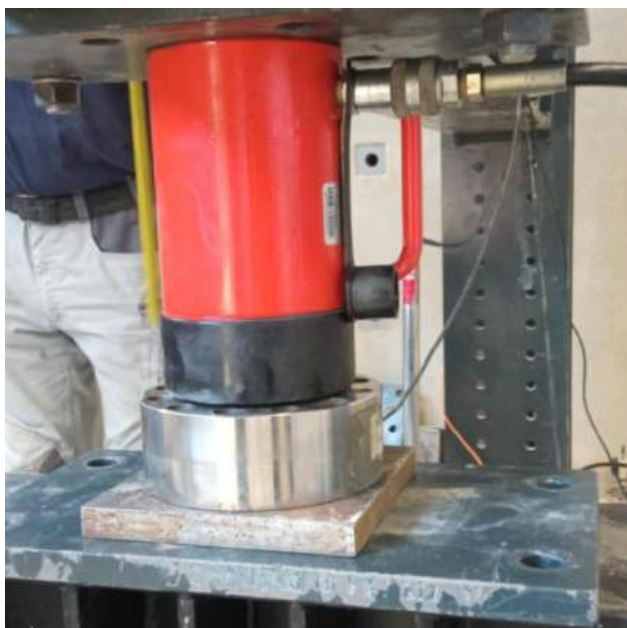
Slika 4.12: Hidraulička preša i ispod nje mjeri silu Burster 8438-6200 kapaciteta 200 kN
