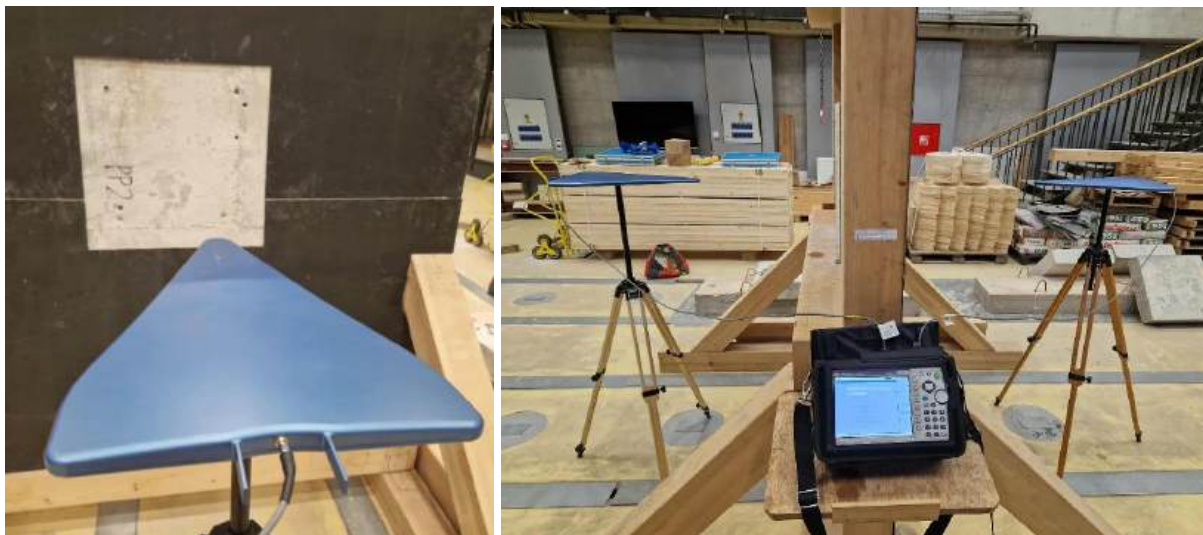
Slika 3.61: Eksperimentalno ispitivanje uzorka plošnog nosača PP2 na zaštitu od EM zračenja Hyperlog antenom
