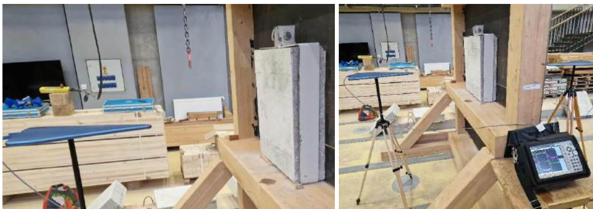
Slika 3.67: Eksperimentalno ispitivanje uzorka plošnog nosača PK2 na zaštitu od EM zračenja Hyperlog antenom
