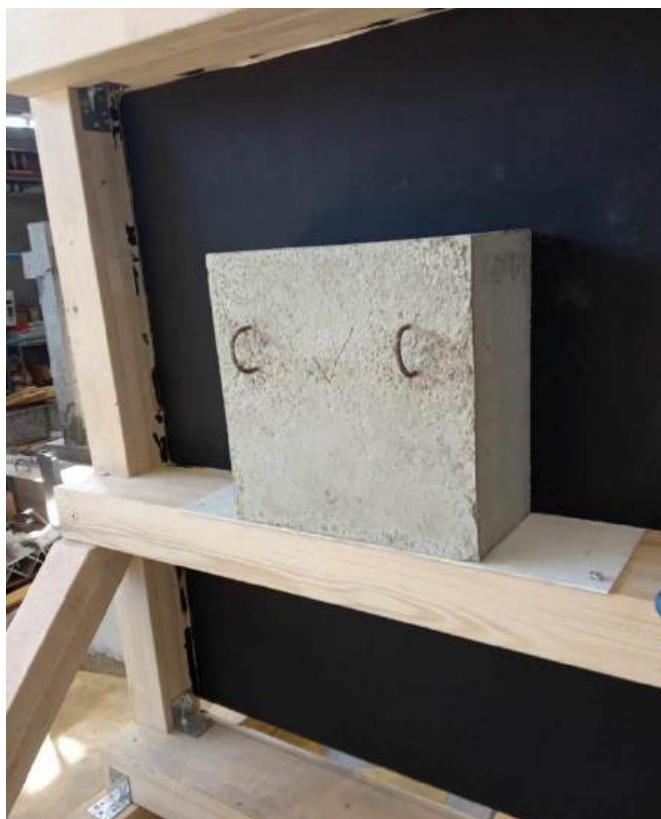
Slika 3.30: Uzorak plošnog nosača na drvenom okviru za ispitivanje
