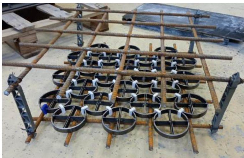
Slika 3.18: Metodologija izrade uzoraka plošnih nosača s ugrađenim čeličnim mikrovalnim rezonatorima
