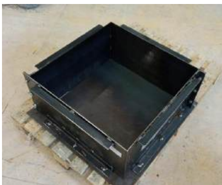
Slika 3.5: Čelični kalup za plošni nosač
