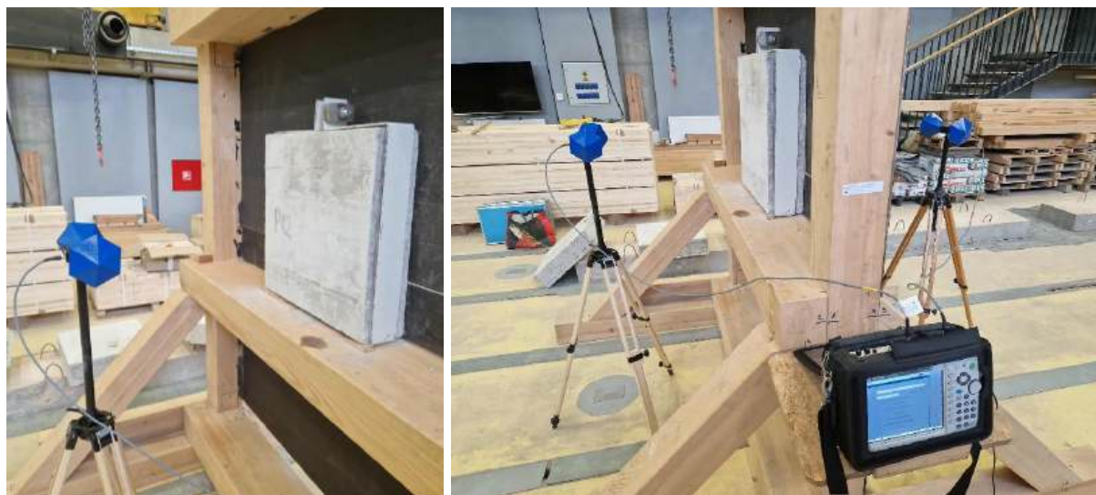
Slika 3.66: Eksperimentalno ispitivanje uzorka plošnog nosača PK2 na zaštitu od EM zračenja Bicollog antenom
