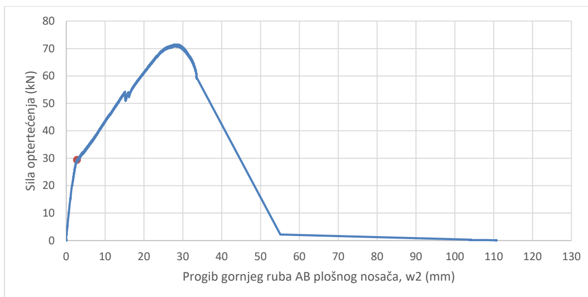
Slika 4.51: Dijagram sila opterećenja - progib gornjeg ruba AB plošnog nosača P-K-3 w_2 (mm) očitani LVDT_2 senzorom
