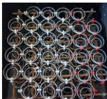
Slika 3.4: Oblik i raspored prstenastih čeličnih mikrovalnih rezonatora
