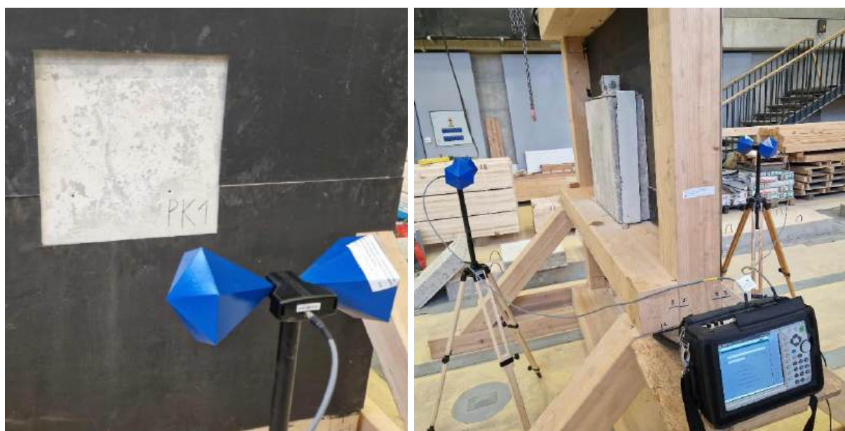
Slika 3.63: Eksperimentalno ispitivanje uzorka plošnog nosača PK1 na zaštitu od EM zračenja Bicolog antenom
