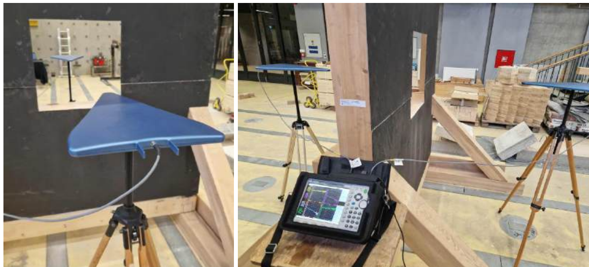
Slika 3.69: Eksperimentalno ispitivanje praznog okvira Hyperlog antenom
