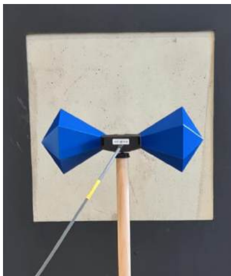
Slika 3.28: Bicollog antena (frekvencijski opseg rada od 50 MHz do 1 GHz)
