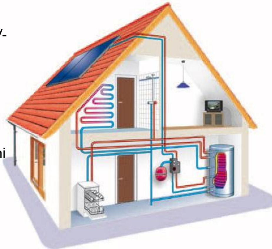
Konfiguracija sustava zagrijavanja PTV sa solarnim kolektorima
