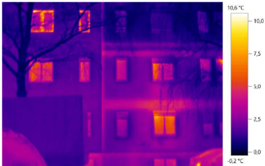
Termografska snimka usporedbe detalja izoliranog i neizoliranog pročelja postojeće zgrade)
