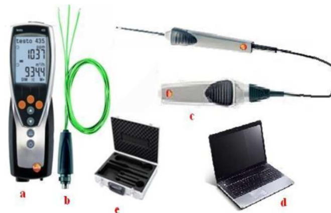
a) glavni multifunkcionalni uređaj b) senzori za mjerenje prolaska topline c) uređaj za mjerenje i odašiljanje vanjske temperature zraka d) prijenosno računalo e) kovčeg za prijenos opreme
