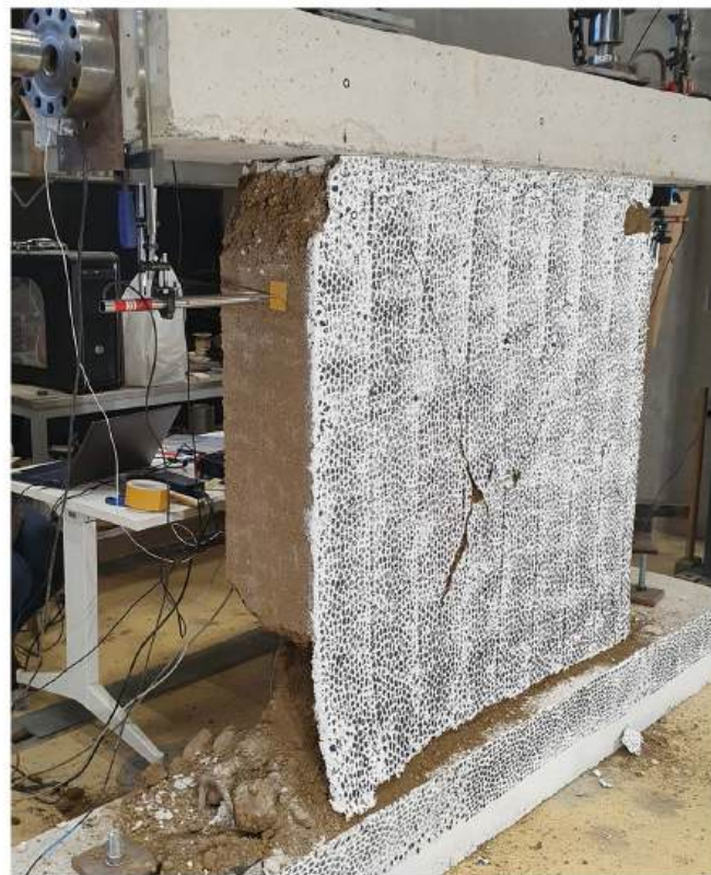
Ispitivanje ravnog zemljanog zida na simulirano djelovanje potresa
