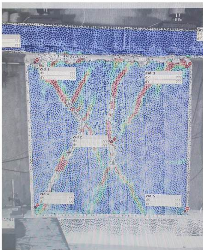
Bilježenje deformacija zemljanog zida pri cikličkom djelovanju
