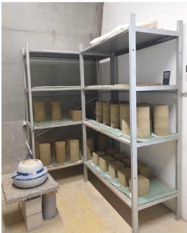
Njega uzoraka za određivanje fizikalnih i mehaničkih svojstava nabijene zemlje
