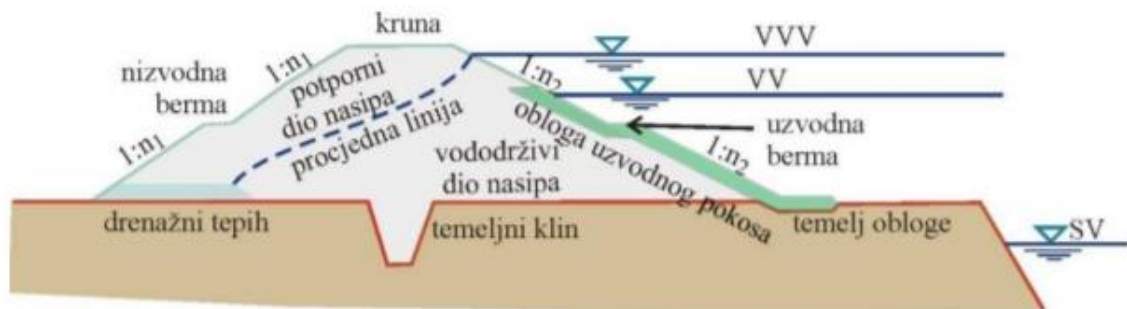
Slika 6.4 Hidrotehnički nasip s bitnim dijelovima
