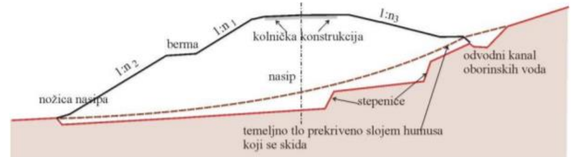
Slika 6.2 Cestovni nasip s bitnim dijelovima
